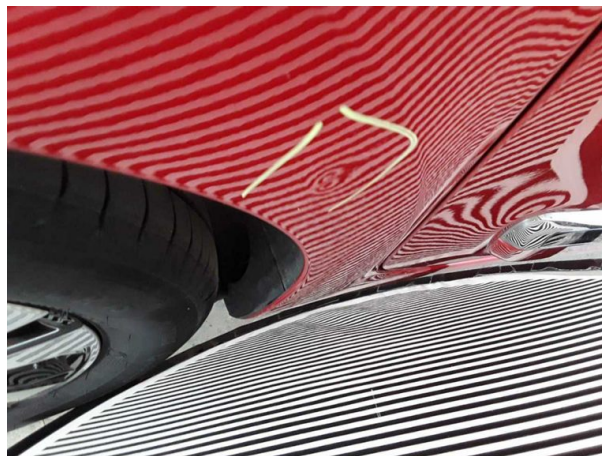
Beschädigung #1: Seitenwand rechts: Seitenwand - Delle(n) - sanft instandsetzen
