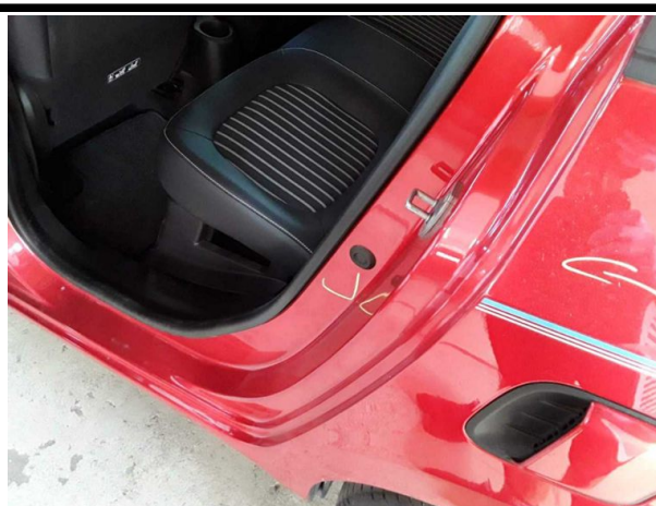
Beschädigung #4: Seitenwand links: Einstieg - Delle(n) - sanft instandsetzen
