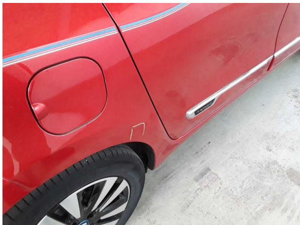
Beschädigung #1: Seitenwand rechts: Seitenwand - Delle(n) - sanft instandsetzen
