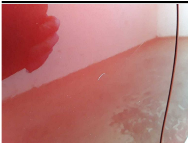
Beschädigung #3: Tür hinten rechts: Tür - Kratzer - Smart Repair
