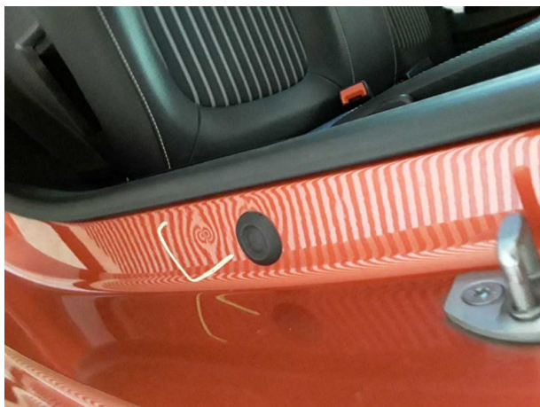
Beschädigung #4: Seitenwand links: Einstieg - Delle(n) - sanft instandsetzen
