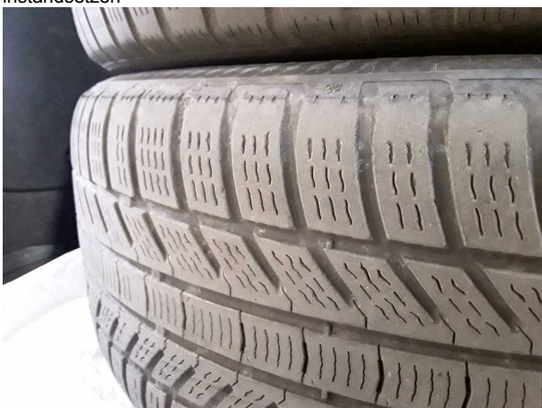
Beschädigung #2: 2.Radsatz: 2 Reifen (2 x Winterreifen unter 4 mm Profiltiefe) - entspricht nicht den Leasingvorgaben - erneuern
