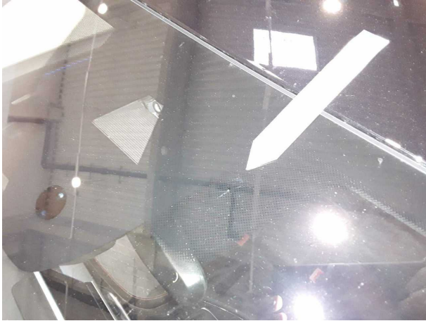
Beschädigung #4: Verglasung: Frontscheibe - Steinschlag - erneuern
