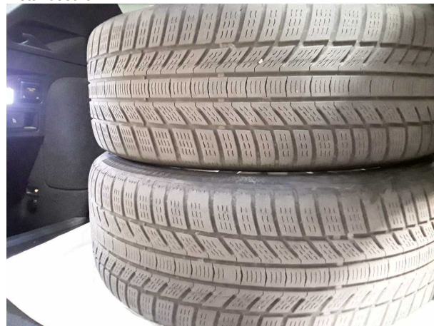
Beschädigung #2: 2.Radsatz: 2 Reifen (2 x Winterreifen unter 4 mm Profiltiefe) - entspricht nicht den Leasingvorgaben -
