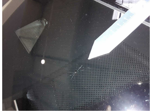
Beschädigung #4: Verglasung: Frontscheibe - Steinschlag - erneuern
