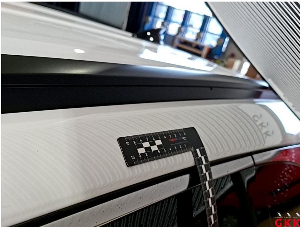
Bild 26. Dach, Holm links, beschädigt, kalt drücken
