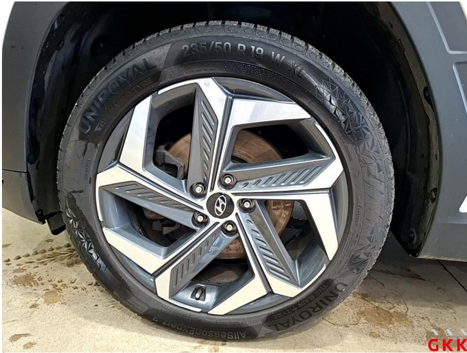
Bild 27. Reifen, vorn links und rechts, falsche Reifenart, ersetzen
