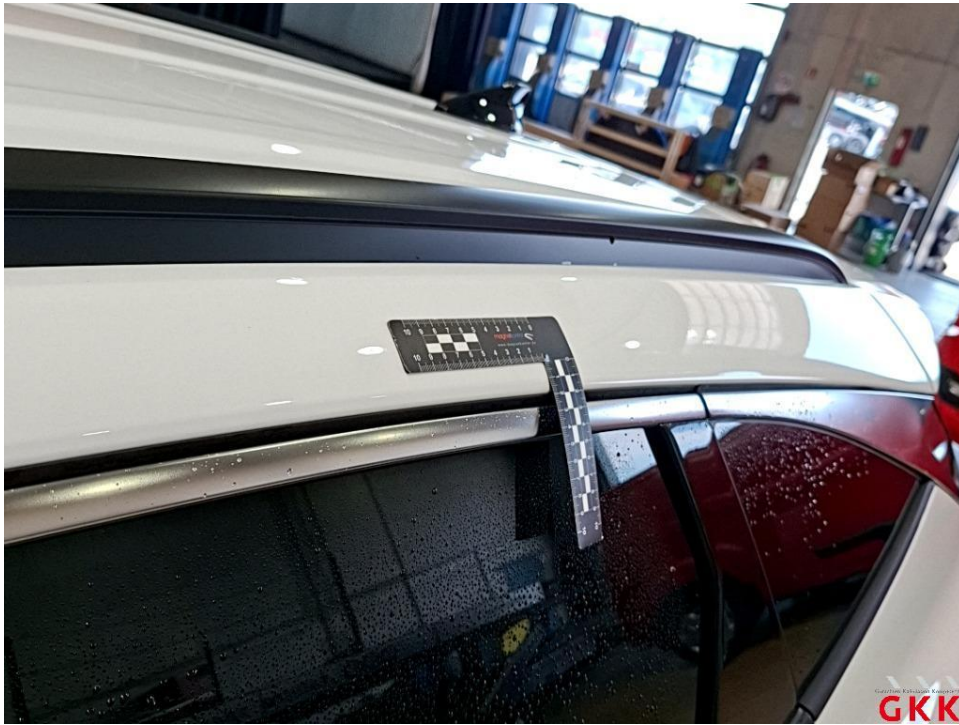
Bild 25. Dach, Holm links, beschädigt, kalt drücken
