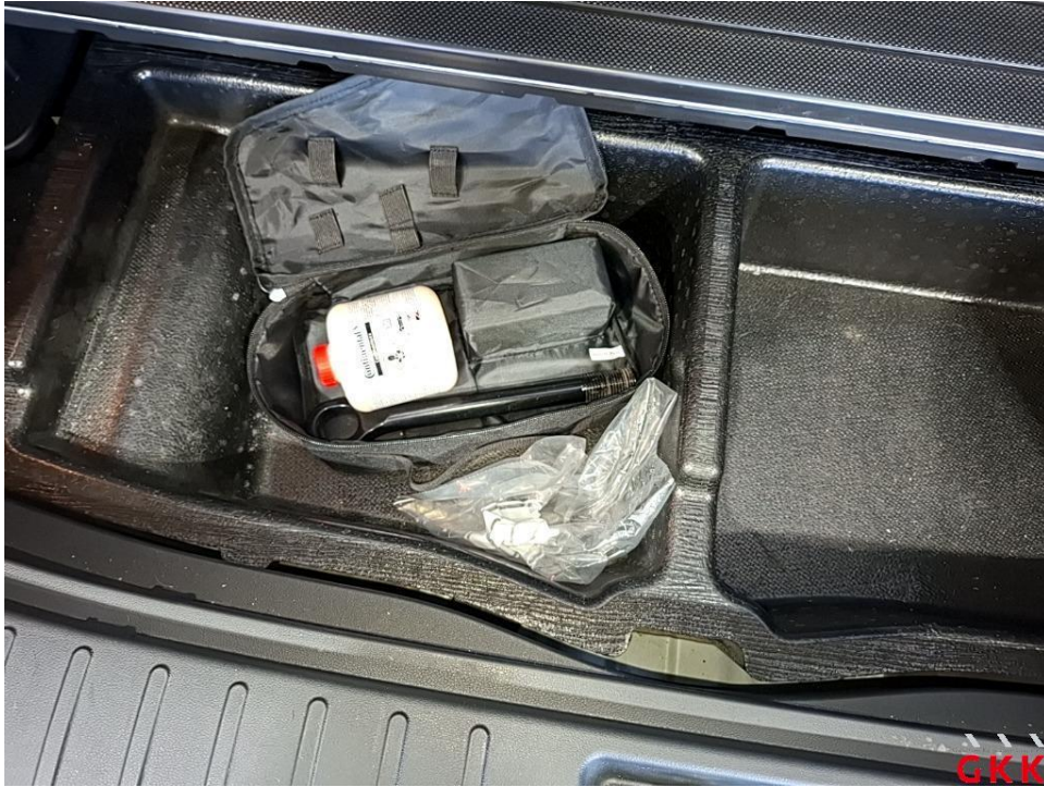
Bild 13. Reifenreparaturset, Füllkompressor, fehlt, ersetzen
