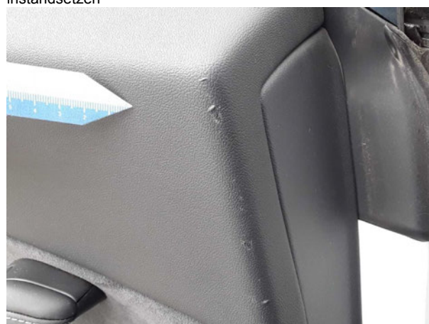
Beschädigung #3: Verkleidungen/Abdeckungen: Türverkleidung hinten links - verkratzt / verschürft - erneuern
