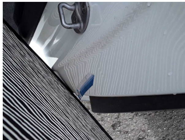
Beschädigung #1: Seitenwand links: Einstieg - Delle(n) - Smart Repair
