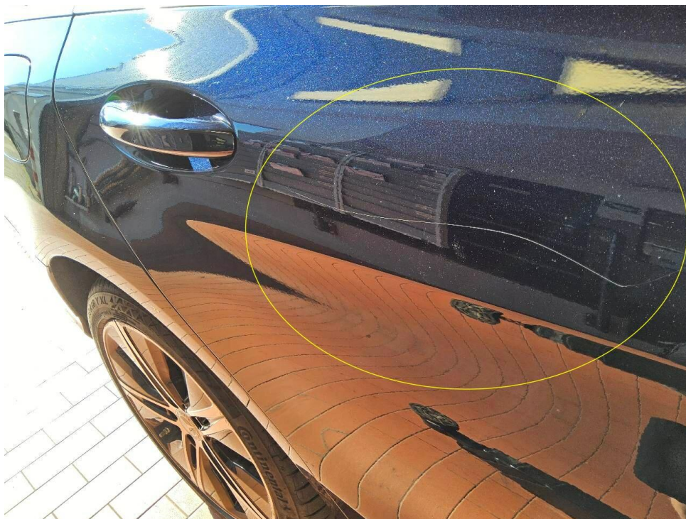
Bild 10 : Türe hinten rechts Kratzer
