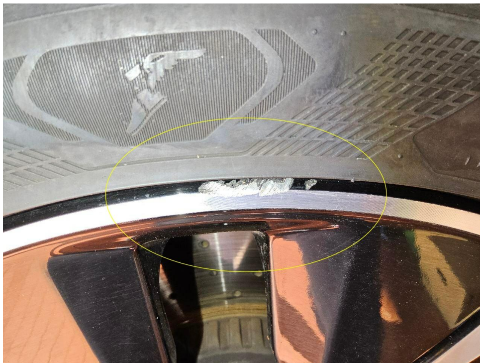
Bild 21 : Felge vorne rechts stark verschrammt
