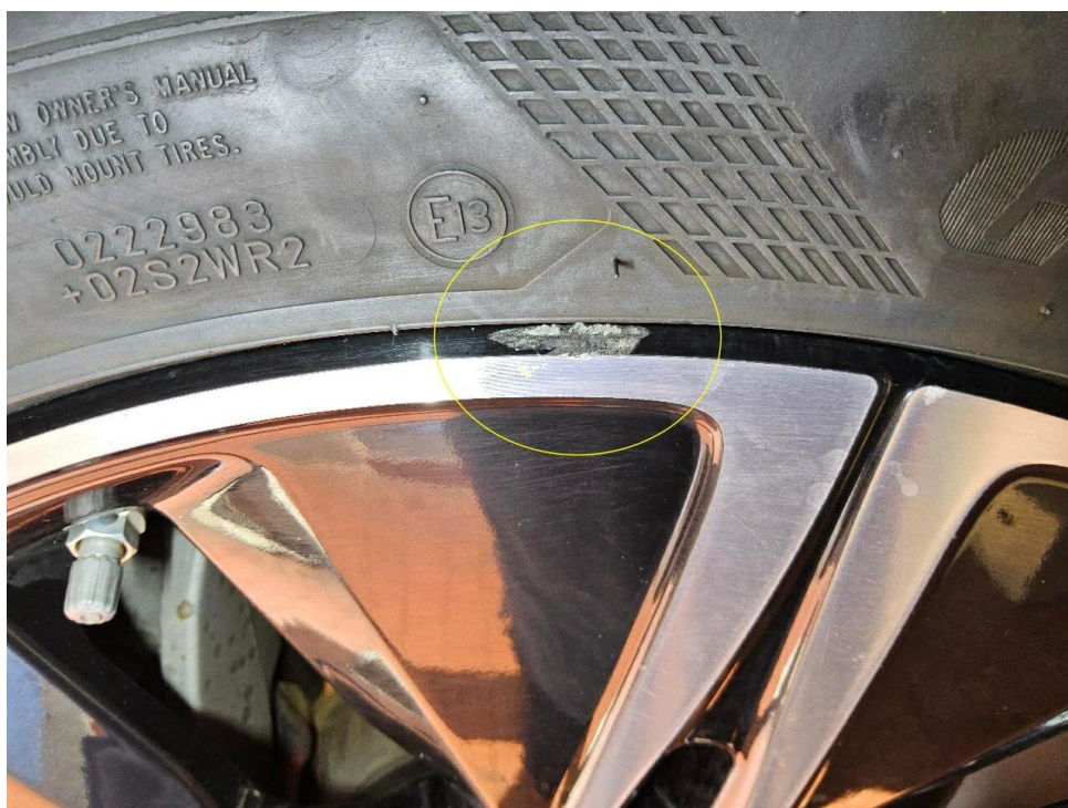
Bild 20 : Felge vorne rechts stark verschrammt
