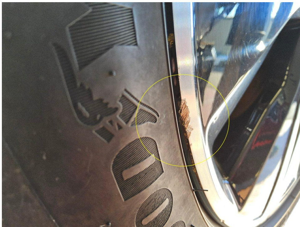
Bild 16 : Felge vorne links stark verschrammt
