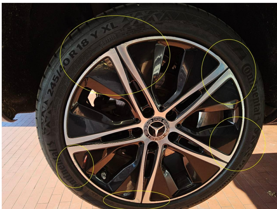
Bild 18 : Felge hinten rechts stark verschrammt
