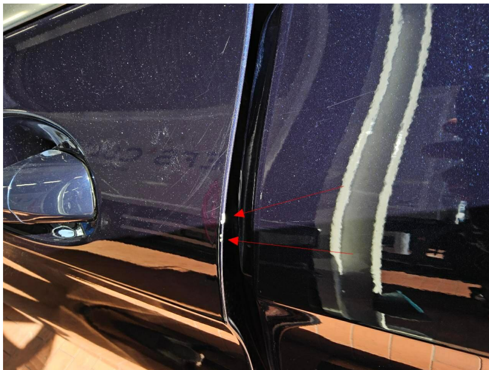
Bild 8 : Türe vorne links Türkante Lackabplatzer und abschürfungen
