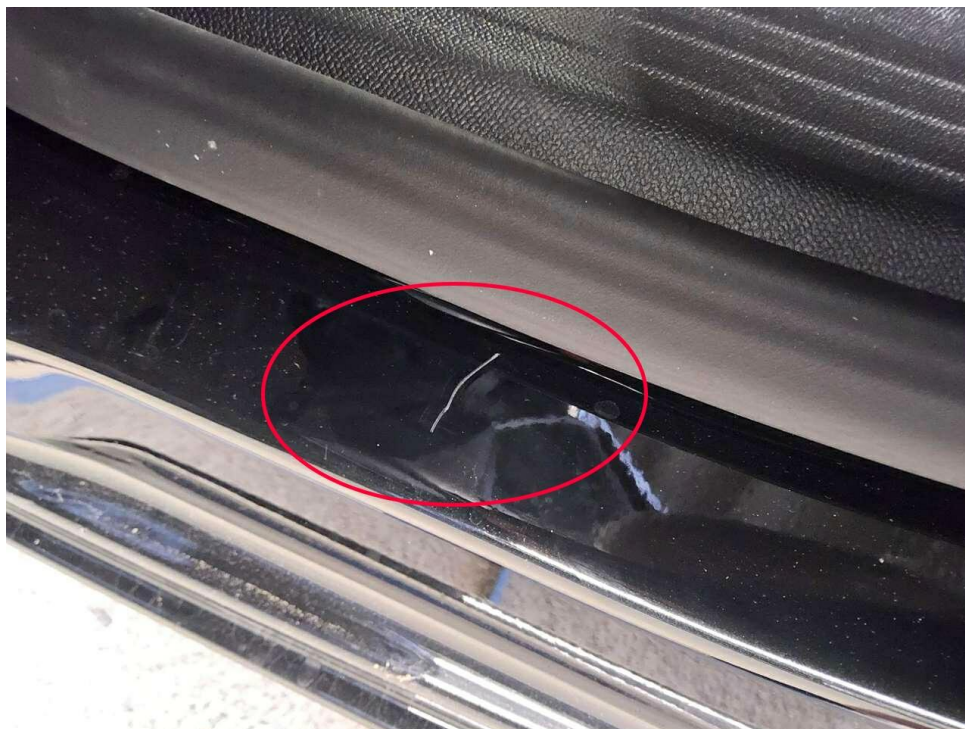
Bild 15 : Tür hinten links Einstieg Lackierung, zerkratzt, smart repair
