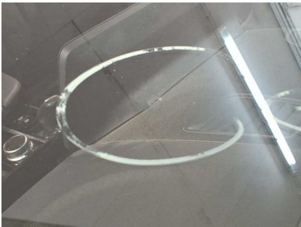
Beschädigung #10: Verglasung: Frontscheibe - Steinschlag - erneuern
