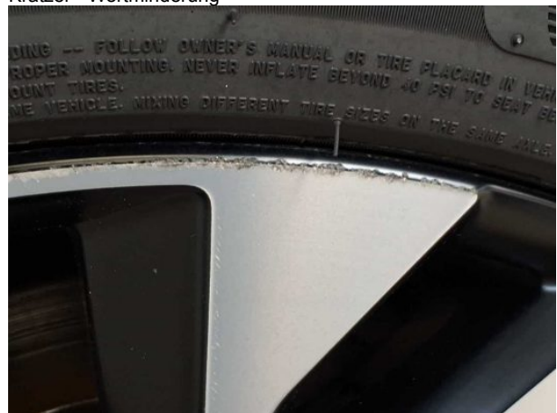
Beschädigung #10: Rad/Reifen: Leichtmetallfelge hinten rechts - Kratzer - Wertminderung
