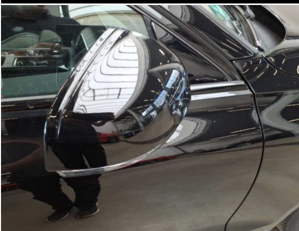
Beschädigung #8: Außenspiegel rechts: Abdeckkappe - Kratzer - instandsetzen und lackieren
