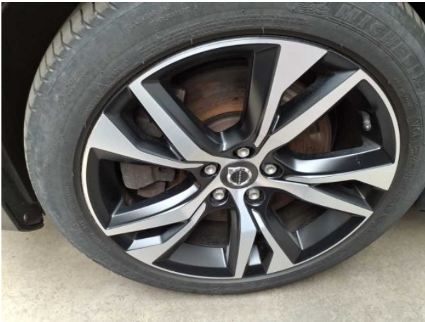
Beschädigung #9: Rad/Reifen: Leichtmetallfelge vorn links - Kratzer - Wertminderung
