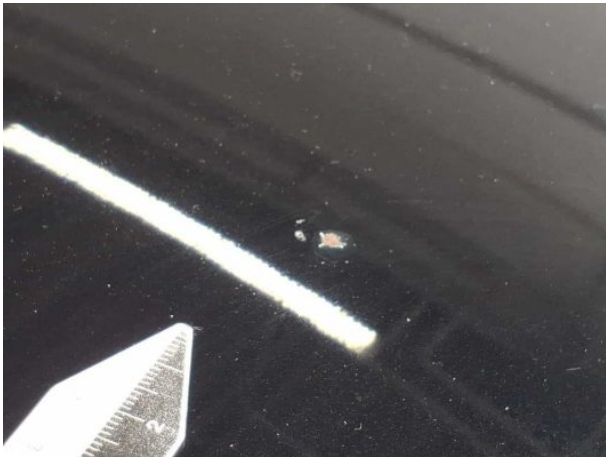
Beschädigung #13: Fahrzeugdach: Dach - Korrosion - instandsetzen und lackieren
