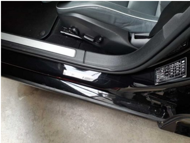
Beschädigung #6: Schweller links: Einstieg - Kratzer - Smart Repair
