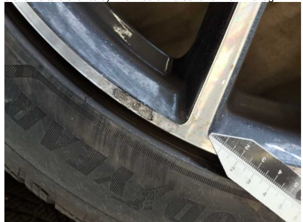
Beschädigung #2: 2.Radsatz: 1 Leichtmetallfelge (Im Fahrzeug liegend) - Kratzer - kein Abzug
