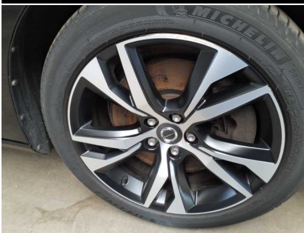
Beschädigung #11: Rad/Reifen: Leichtmetallfelge vorn rechts - Kratzer - Wertminderung
