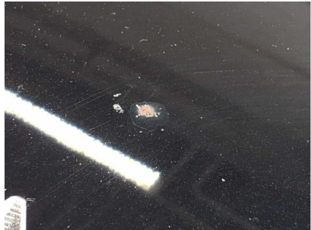
Beschädigung #13: Fahrzeugdach: Dach - Korrosion - instandsetzen und lackieren
