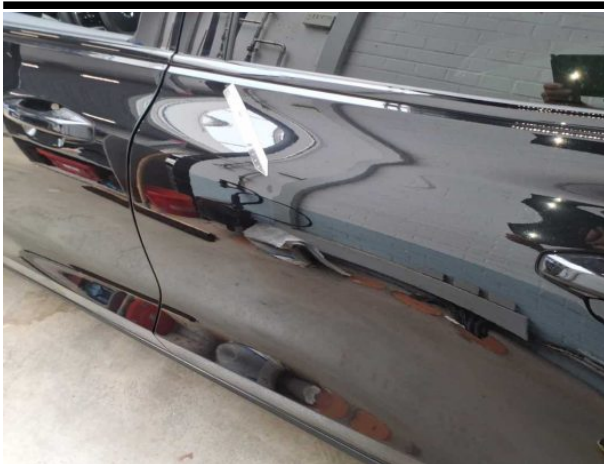
Beschädigung #5: Tür hinten links: Tür - Delle(n) - sanft instandsetzen
