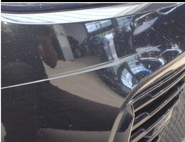
Beschädigung #12: Stossfänger vorn: Stossfänger vorn - verkratzt / verschürft - instandsetzen und lackieren
