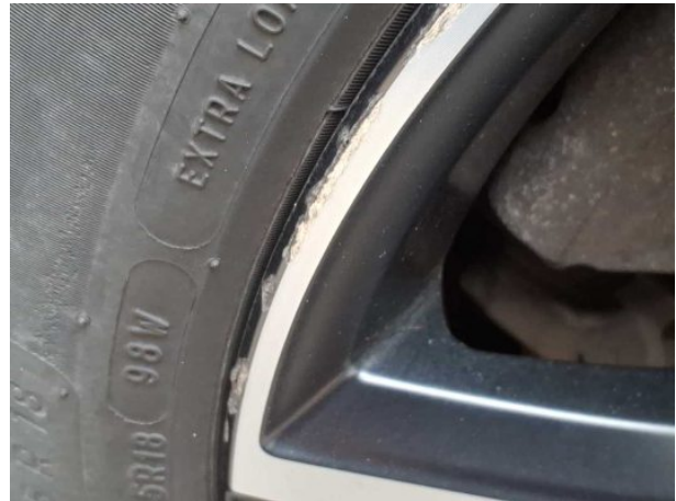
Beschädigung #9: Rad/Reifen: Leichtmetallfelge vorn links - Kratzer - Wertminderung
