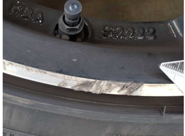
Beschädigung #1: 2.Radsatz: 1 Leichtmetallfelge (Abrieb sicherheitsrelevante 3) - verkratzt / verschürft - kein Abzug
