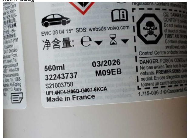
Beschädigung #4: Ausrüstung: Tirefit Füllmittel - abgelaufen - erneuern
