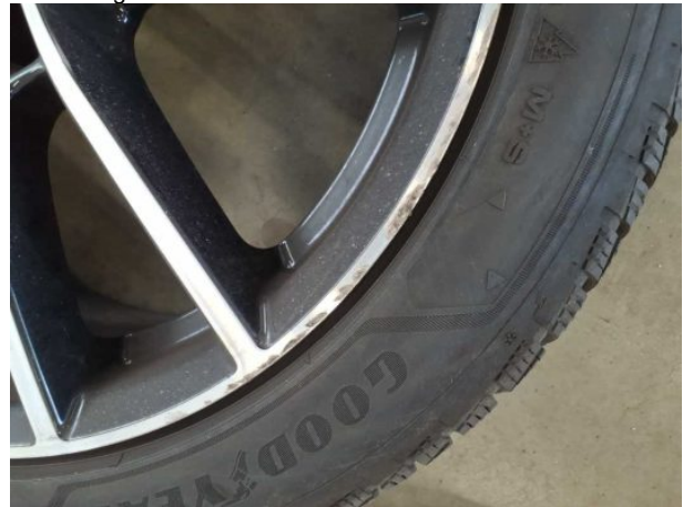
Beschädigung #3: 2.Radsatz: 1 Leichtmetallfelge - Kratzer - kein Abzug
