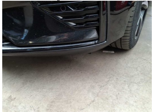
Beschädigung #12: Stossfänger vorn: Stossfänger vorn - verkratzt / verschürft - instandsetzen und lackieren
