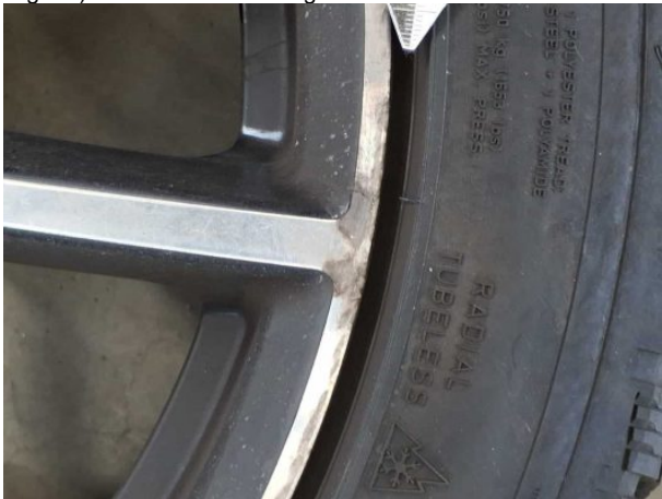
Beschädigung #3: 2.Radsatz: 1 Leichtmetallfelge - Kratzer - kein Abzug
