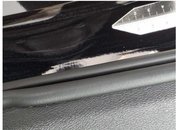
Beschädigung #6: Schweller links: Einstieg - Kratzer - Smart Repair
