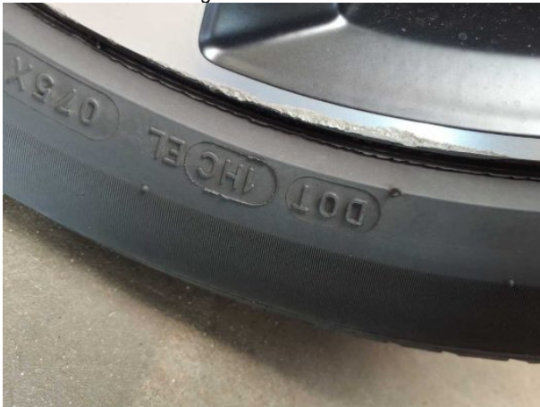
Beschädigung #11: Rad/Reifen: Leichtmetallfelge vorn rechts - Kratzer - Wertminderung
