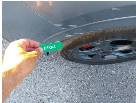
Moldura de aleta / Delantero Izquierdo / Rayado
