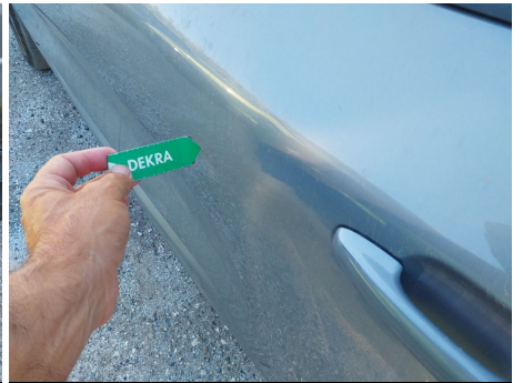
Puerta / Trasero Izquierdo / Abolladura
