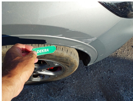
Moldura de aleta / Delantero Derecho / Rayado
