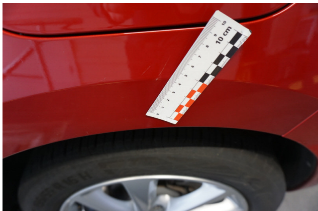
Beschädigung #5: Seitenwand links: Seitenwand - Kratzer - lackieren
