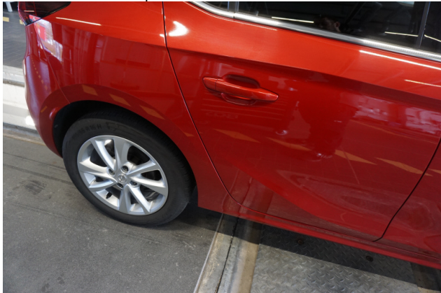
Beschädigung #2: Seitenwand rechts: Radlauf - Kratzer - Smart Repair
