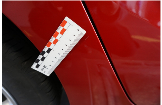
Beschädigung #2: Seitenwand rechts: Radlauf - Kratzer - Smart Repair
