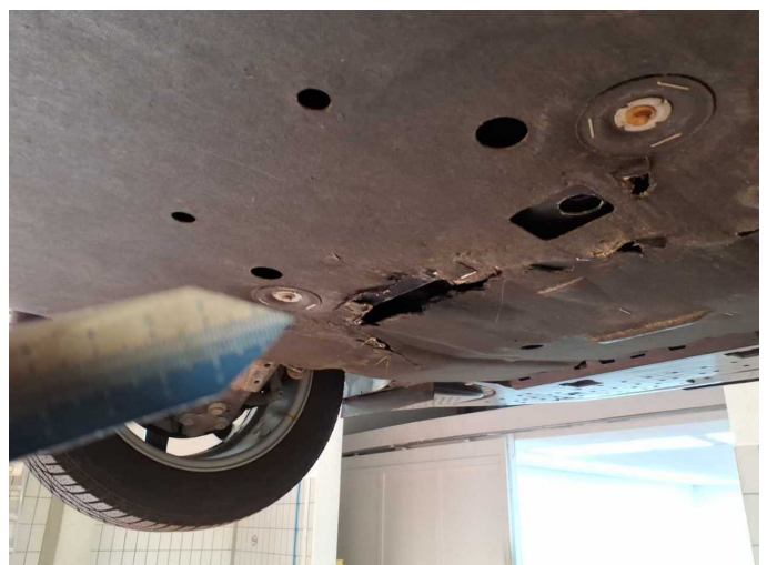
Damage 6: Body: Underbody panelling (Mehrkosten können entstehen) - Broken / torn - Replace
