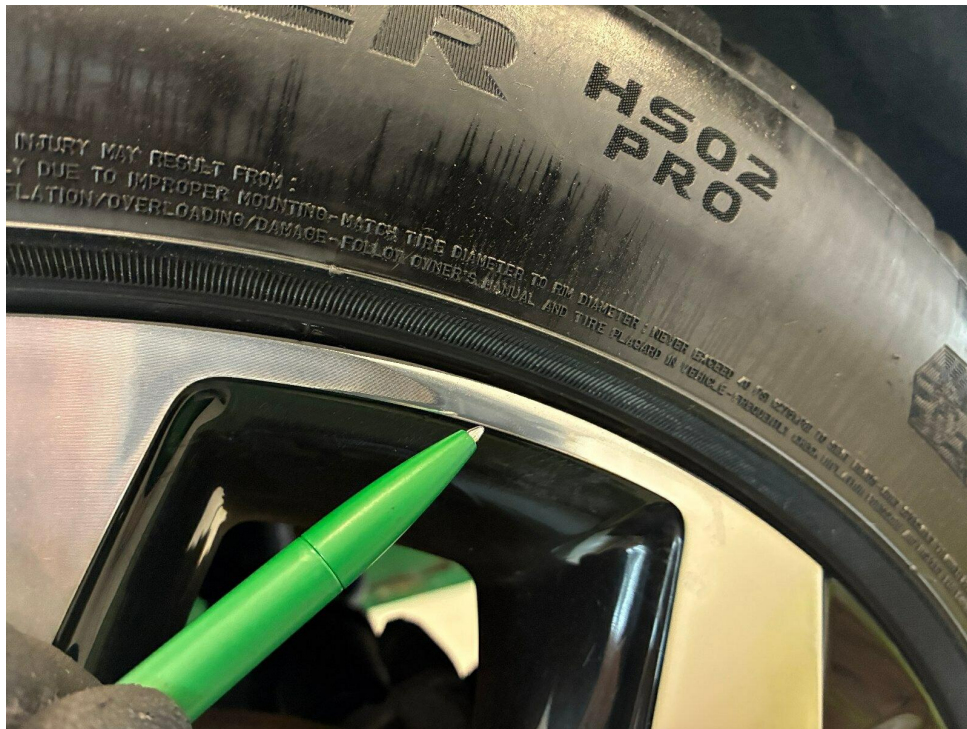
Bild 11 : LM-Felge hinten links Restreparaturspuren
