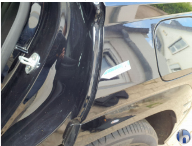
10. Seitenwand - Hinten - Links Kratzer - Smart Repair
