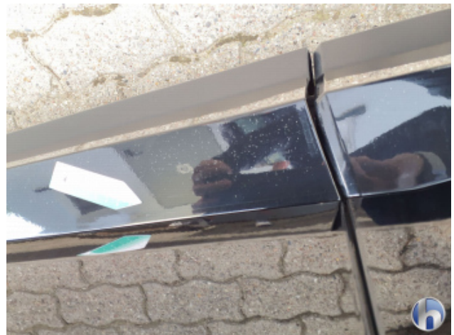
8. Tür Vorne - Rechts Kratzer - Lackieren
