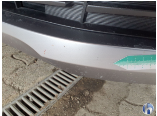
9. Stoßfänger Vorne Gebrauchsspuren - Ohne Reparatur
