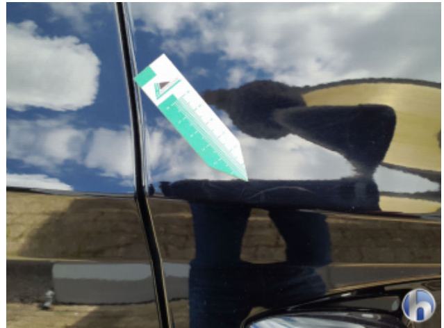
8. Tür Vorne - Rechts Kratzer - Lackieren
