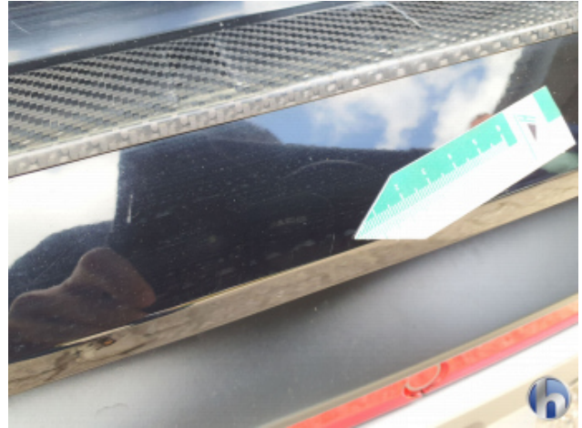
2. Stoßfänger Hinten Kratzer - Smart Repair
