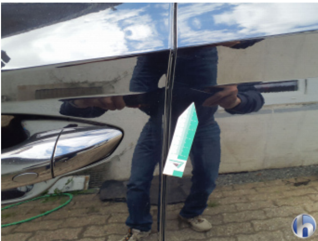
6. Tür Hinten - Links Kratzer - Lackieren
