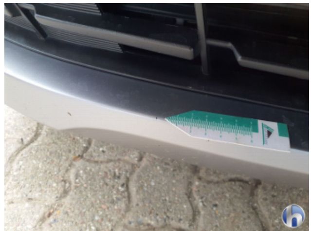
9. Stoßfänger Vorne Gebrauchsspuren - Ohne Reparatur
