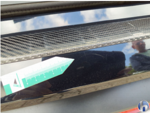
2. Stoßfänger Hinten Kratzer - Smart Repair
