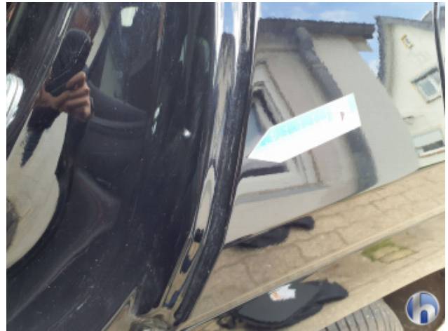
10. Seitenwand - Hinten - Links Kratzer - Smart Repair
