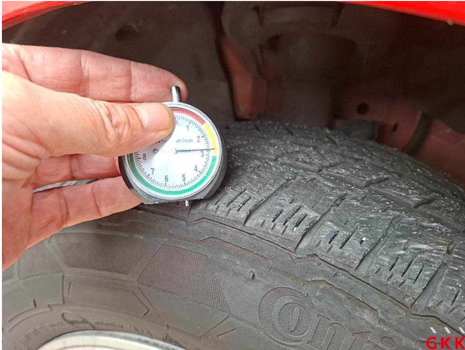
Bild 13. Reifen, vorne rechts, Untermaß, ersetzen
