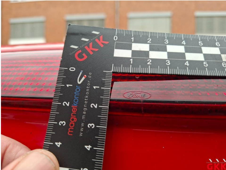
Bild 39. Zusatzbremsleuchte, gerissen, ersetzen
