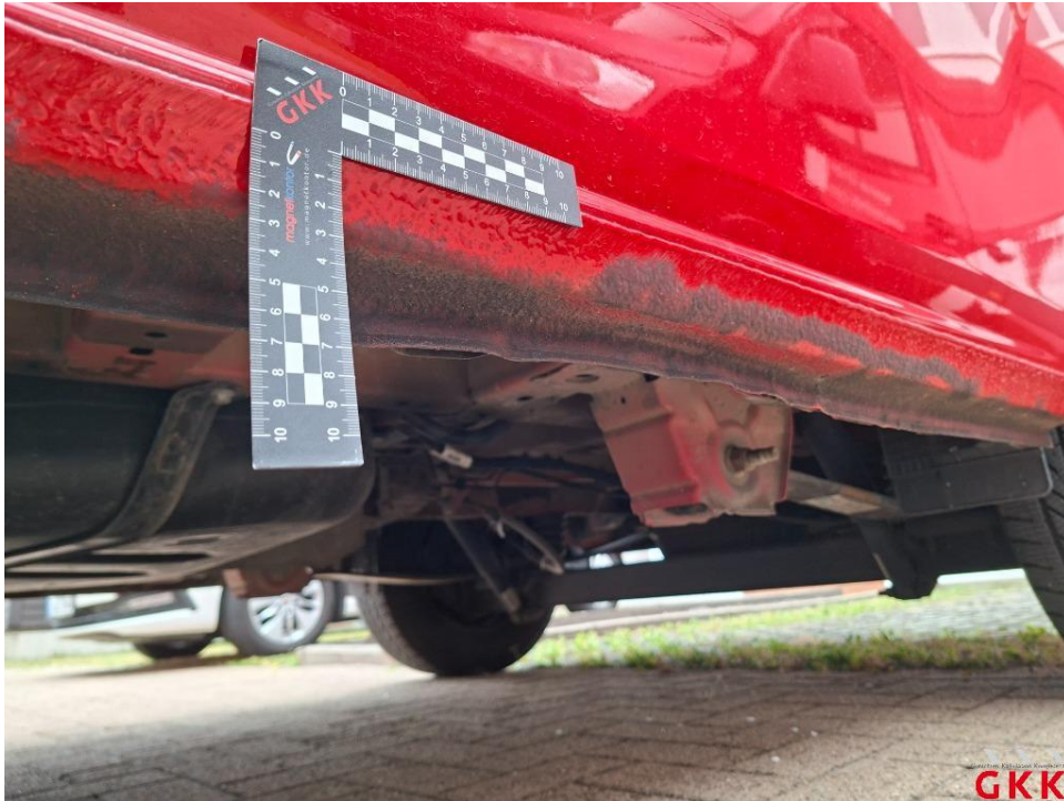
Bild 27. Schweller links, beschädigt, instand setzen - lackieren
