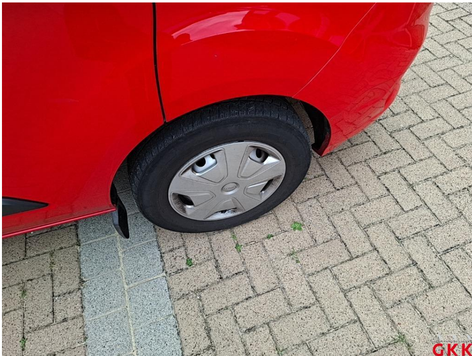
Bild 12. Reifen, vorne rechts, Untermaß, ersetzen
