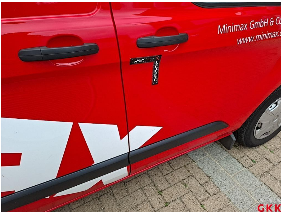
Bild 28. Tür vorne rechts, beschädigt, kalt drücken
