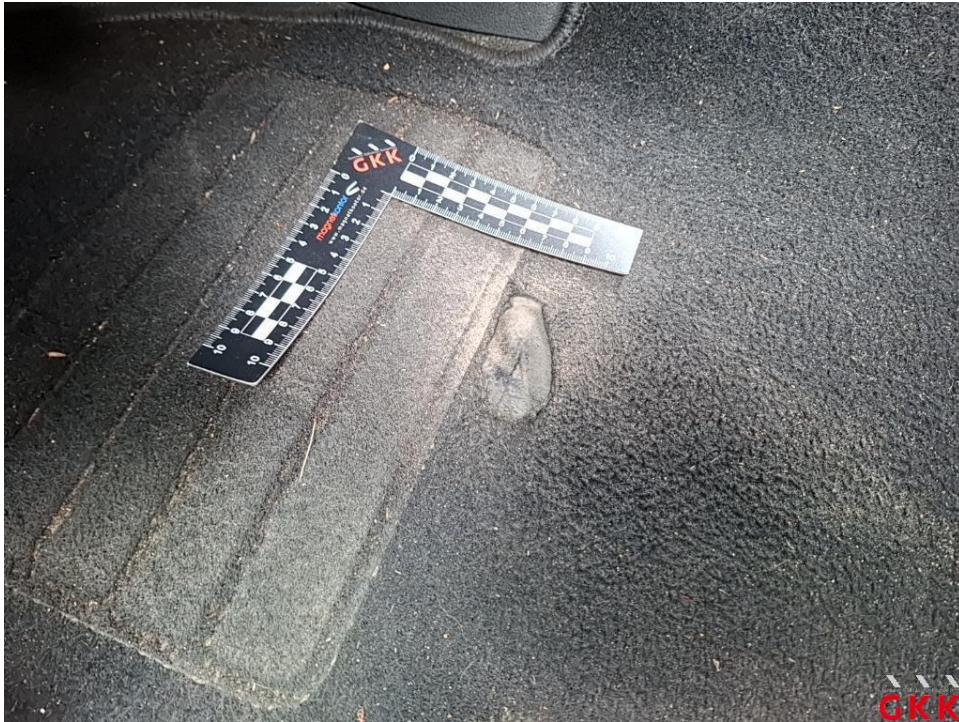
Bild 35. Fußmatte(n), Satz, beschädigt, ersetzen
