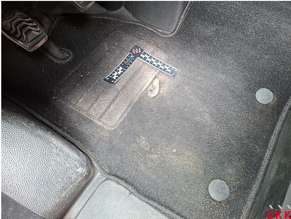
Bild 34. Fußmatte(n), Satz, beschädigt, ersetzen
