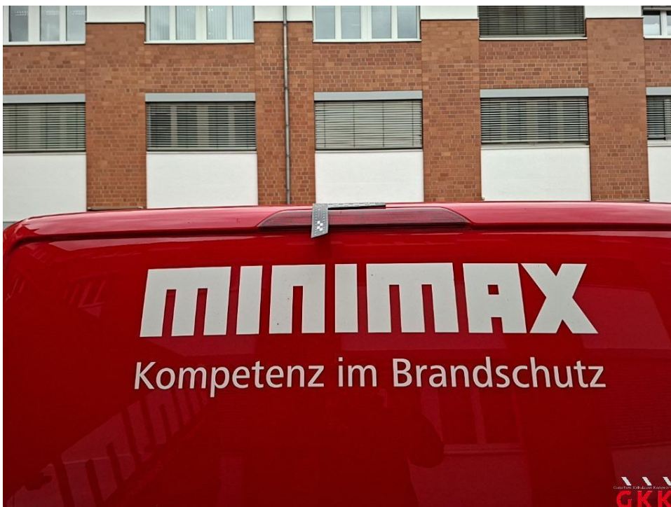
Bild 38. Zusatzbremsleuchte, gerissen, ersetzen
