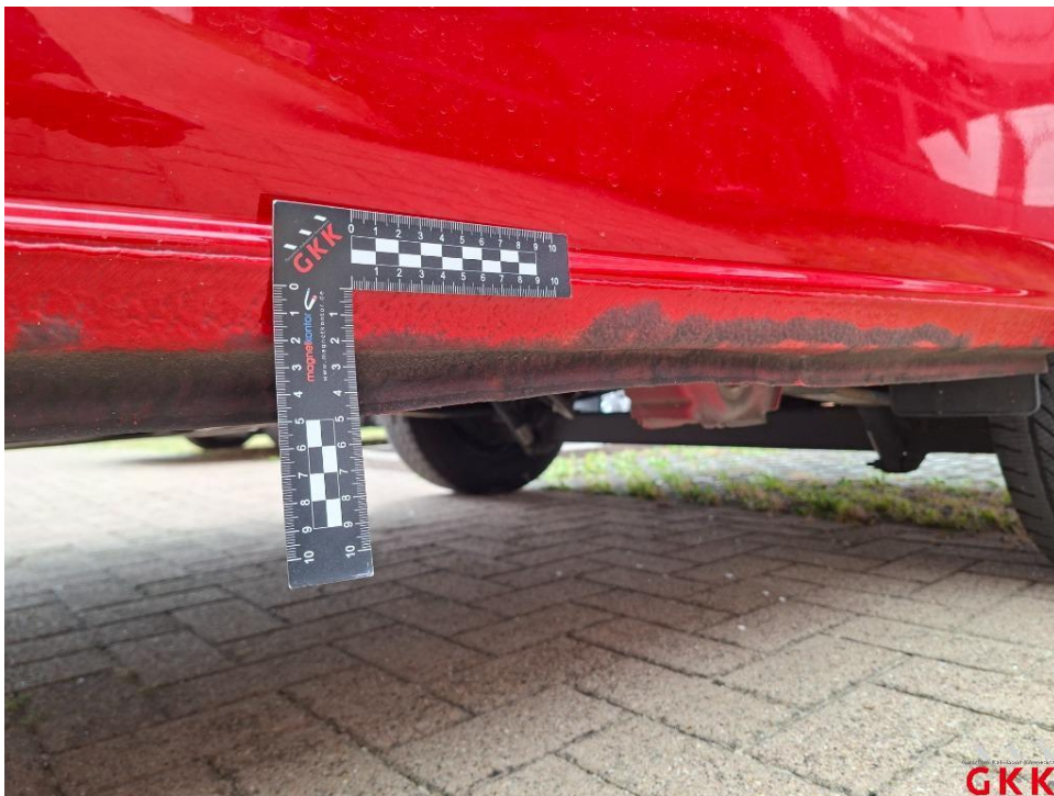
Bild 26. Schweller links, beschädigt, instand setzen - lackieren
