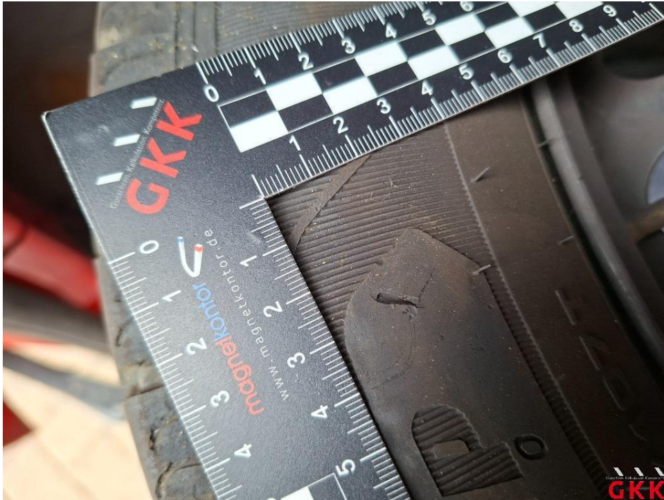
Bild 15. Reifen, 1 x beiliegend, beschädigt, ersetzen
