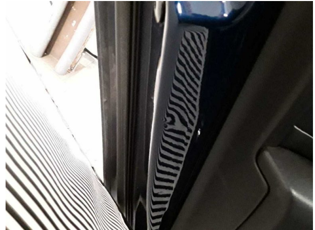
Beschädigung #2: Tür hinten links: Tür - Delle(n) - sanft instandsetzen
