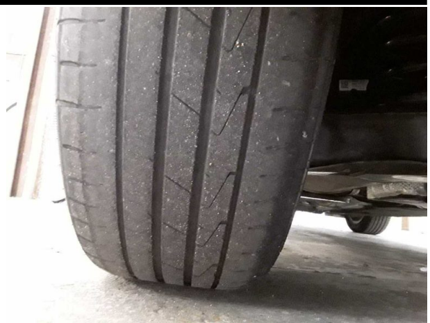
Damage #6: Wheel / tyres: Tyre - right (innen abgefahren) - Worn - Replace
