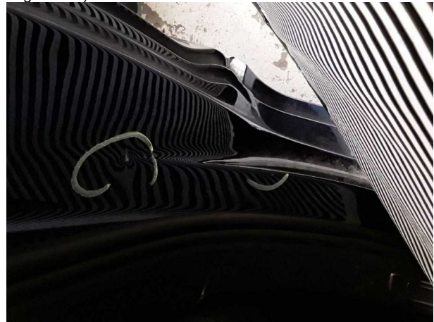
Beschädigung #7: Seitenwand links: Einstieg - Delle / Lackschaden - Smart Repair
