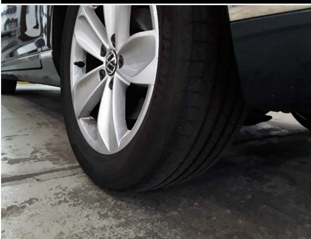
Beschädigung #6: Rad/Reifen: Reifen hinten (innen abgefahren) - verschlissen - erneuern
