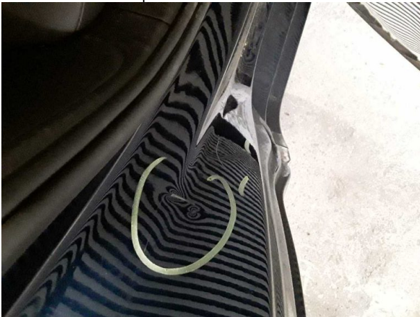
Beschädigung #9: Seitenwand rechts: Einstieg - Delle / Lackschaden - instandsetzen und lackieren
