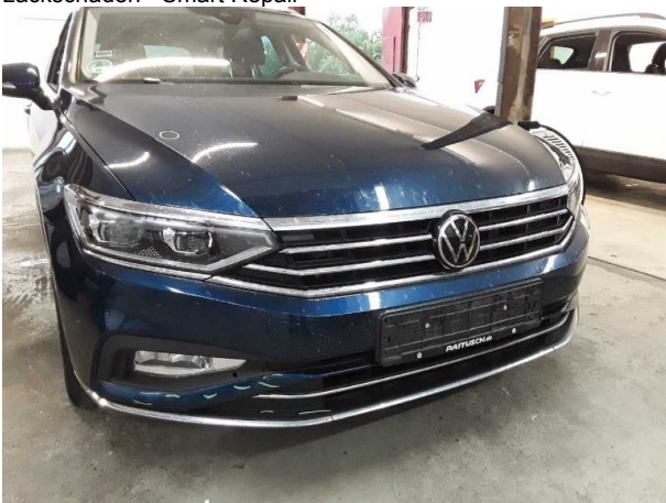
Beschädigung #8: Stossfänger vorn: Stossfänger vorn - verkratzt / verschürft - Smart Repair
