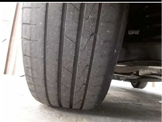
Beschädigung #6: Rad/Reifen: Reifen hinten (innen abgefahren) - verschlissen - erneuern
