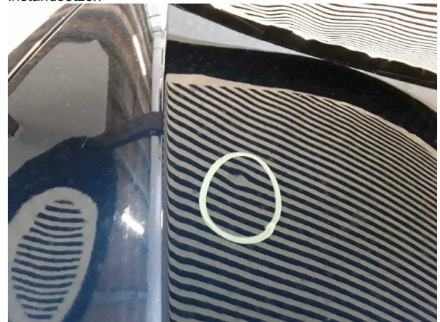
Beschädigung #3: Motorhaube: Motorhaube - Delle(n) - sanft instandsetzen
