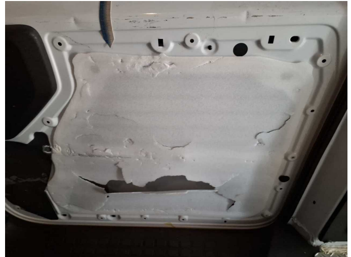
Damage 4: Sliding door, right: Door seal (Dämmung) - Broken / torn - Replace
