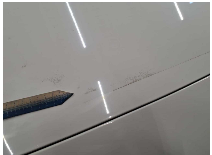
Damage 2: Bonnet: Bonnet (Klebereste) - Soiled - De-glué / neutralise
