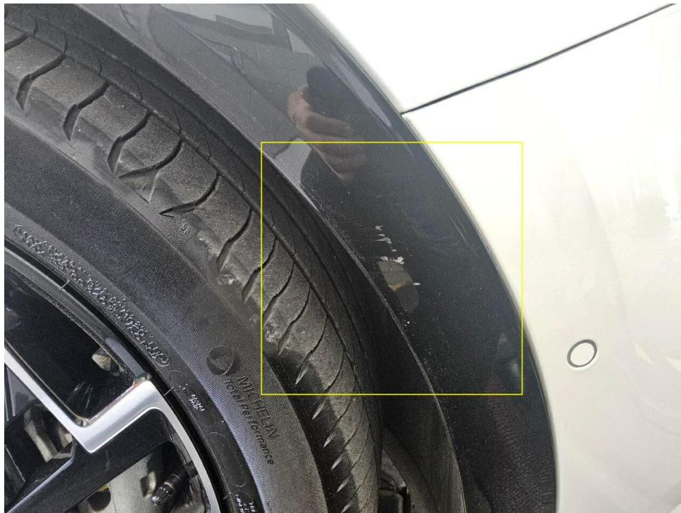
Bild 9 : Kotflügel vorne rechts / Verbreiterung vorne rechts, eingedellt / zerkratzt
