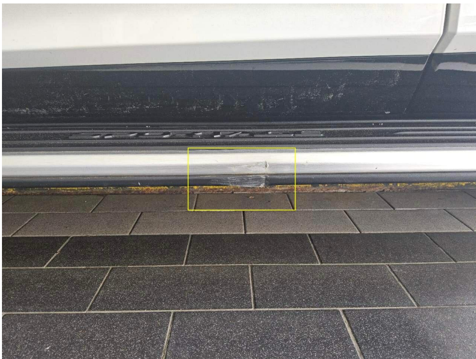
Bild 12 : Türgriff vorne links / Schwellerverkleidung links, zerkratzt / eingedrückt
