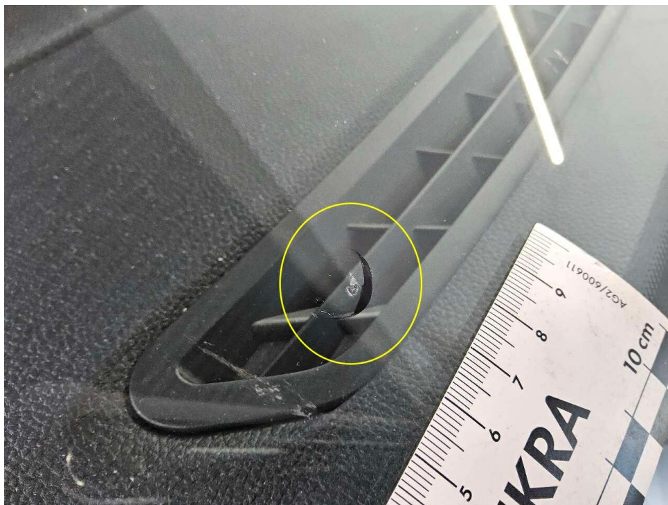
Bild 15 : Frontscheibe Steinschlag mit Rissbildung
