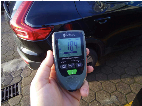
Nachlackierung 1: Kotflügel links, Kotflügel rechts, Seitenwand links, Seitenwand rechts, Tür hinten links, Tür vorne links
