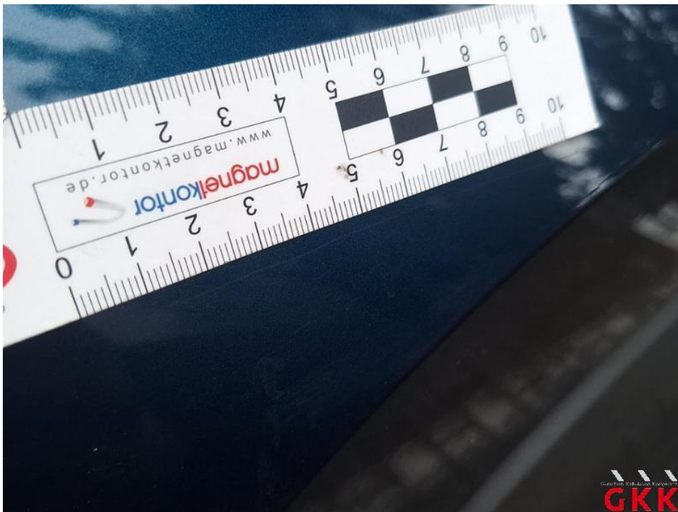
Bild 30. Kotflügel vorne rechts, verkratzt, lackieren
