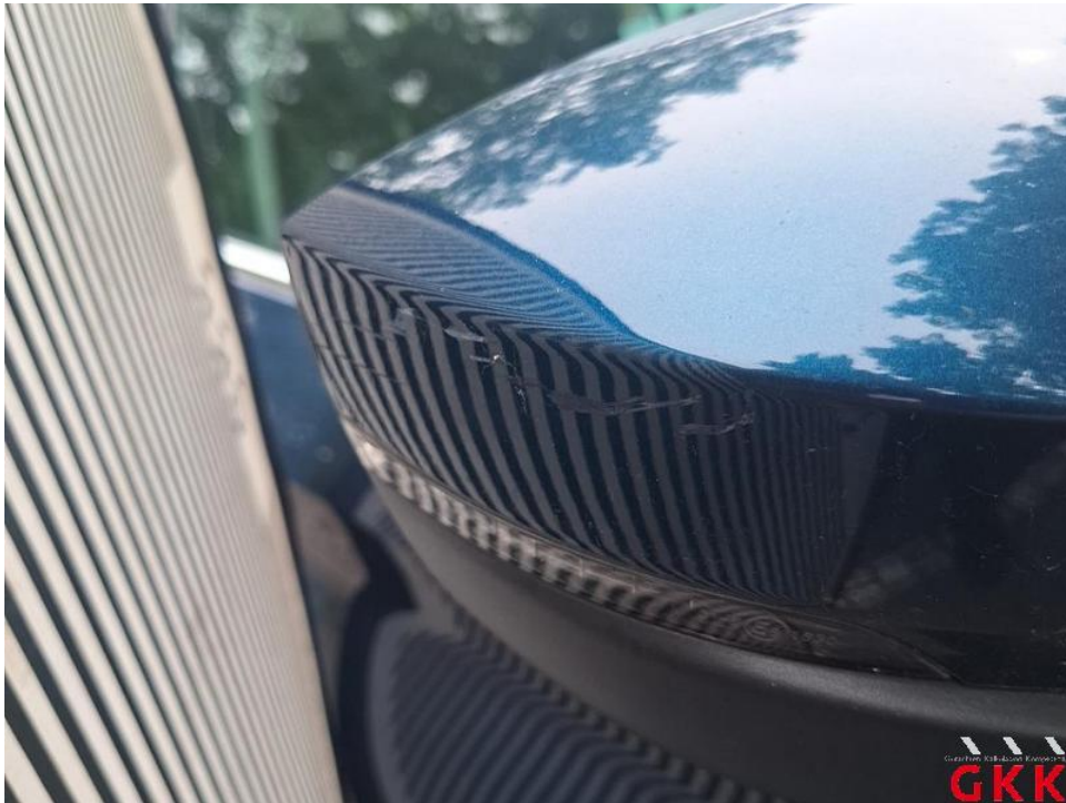
Bild 32. Spiegelgehäuse rechts, Blende -lackiert-, beschädigt, ersetzen
