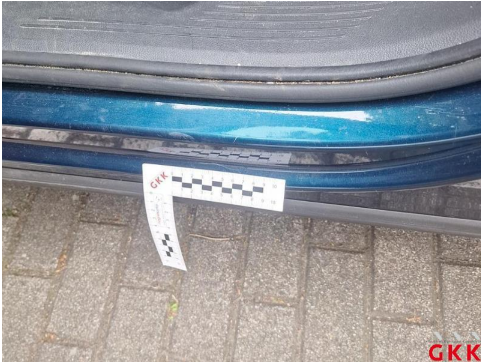
Bild 37. Tür hinten links, Einstieg, verkratzt, lackieren
