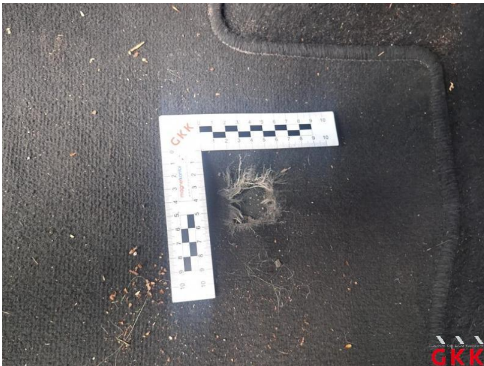
Bild 44. Fußmatte(n), vorne links, beschädigt, ersetzen
