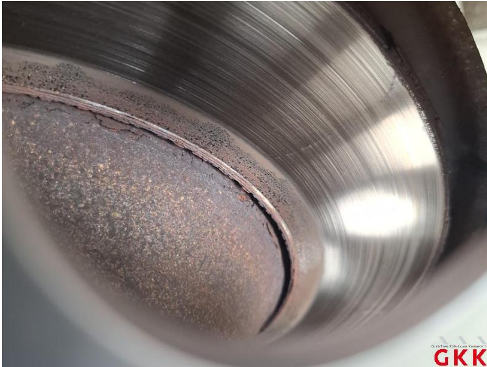
Bild 49. Bremsscheiben, hinten, Tragbild mangelhaft, ersetzen
