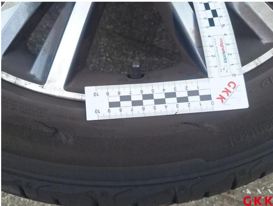
Bild 20. Reifen, vorne rechts, beschädigt, ersetzen
