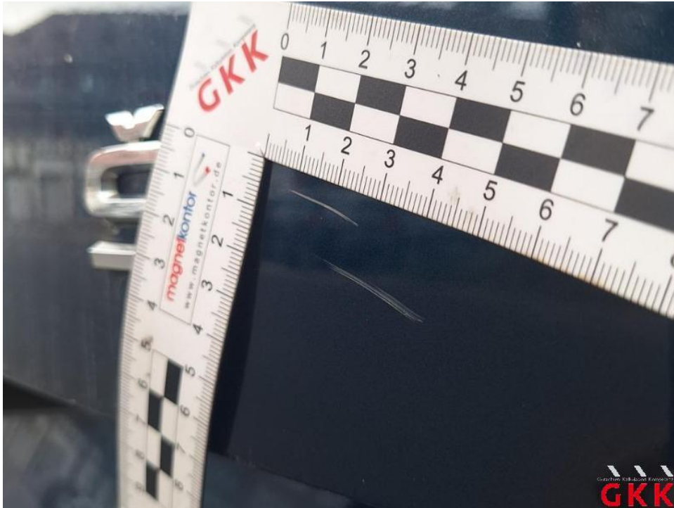
Bild 41. Heckklappe, verkratzt, lackieren
