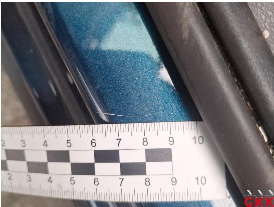
Bild 38. Tür hinten links, Einstieg, verkratzt, lackieren
