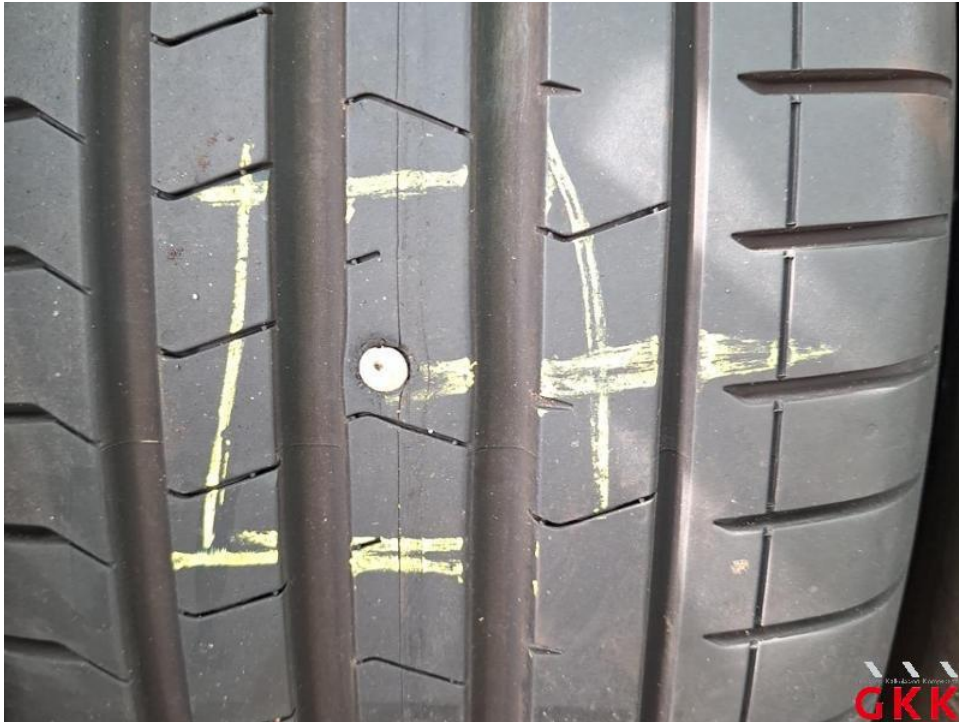
Bild 47. Reifen, hinten links, beschädigt, ersetzen
