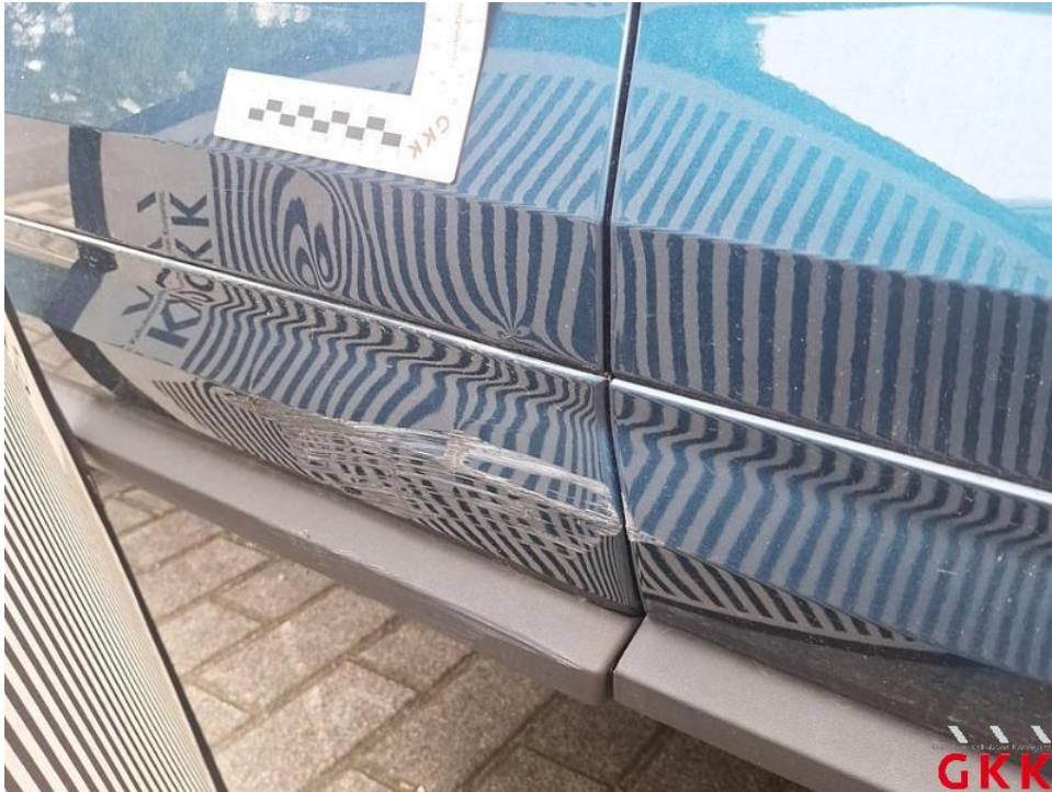
Bild 25. Fahrzeug, Seite rechts, Unfallschaden, Unfallschaden beheben
