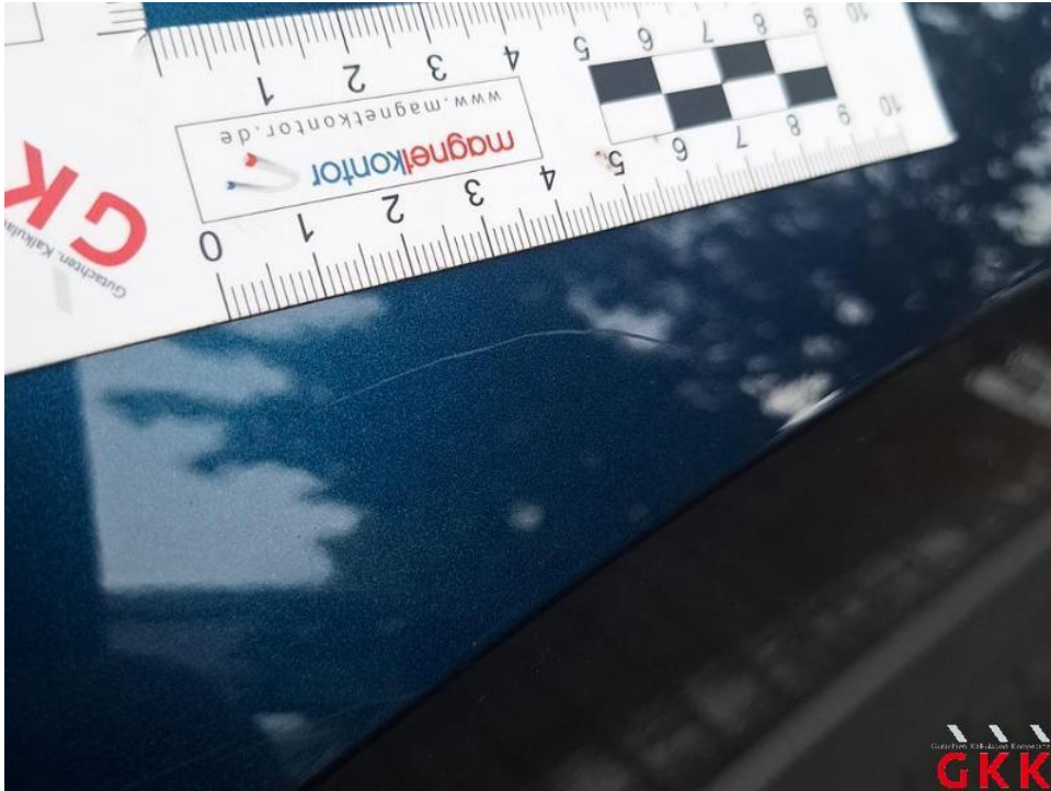
Bild 31. Kotflügel vorne rechts, verkratzt, lackieren
