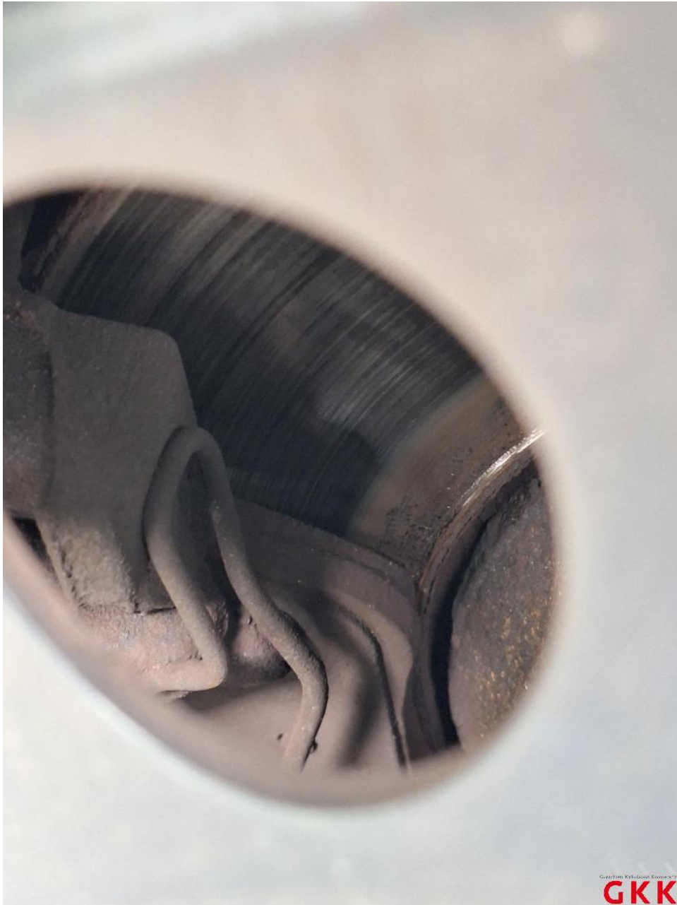
Bild 48. Bremsbeläge, hinten, Untermaß, ersetzen
