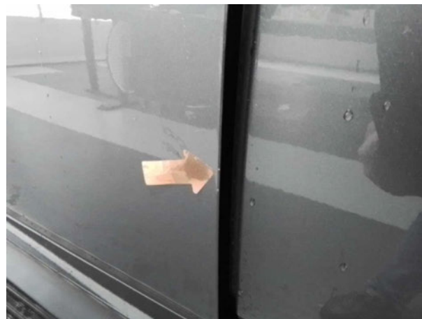
Beschädigung #1: Tür vorn links: Türkante - verkratzt / verschürft... Smart Repair
