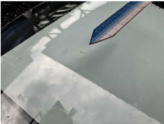
Damage 5: Vehicle glazing: Windscreen (Mit Rissbildung im Fahrersichtfeld) - Stone chips - Replace
