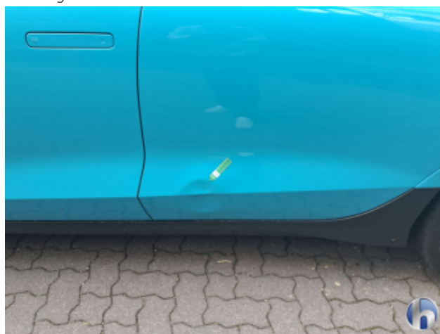
1. Tür Hinten - Links Beschädigt - Instandsetzen und Lackieren
