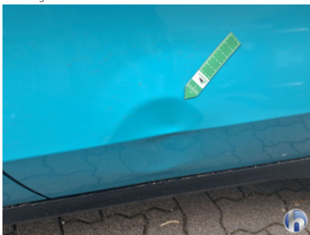
1. Tür Hinten - Links Beschädigt - Instandsetzen und Lackieren
