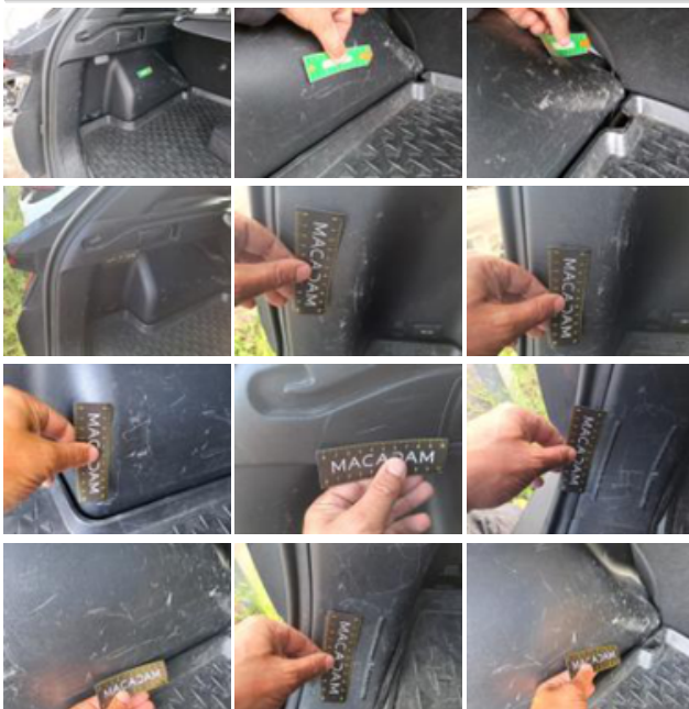
Garnit int D coffre, Griffe(s), E - Remplacer
