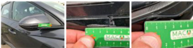
Boîtier rétroviseur ext D, Griffe(s), Acceptable
