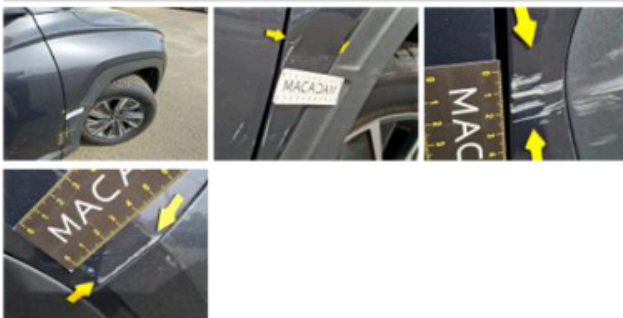
Moulure d'aile AVD, Dégrafé, Acceptable
