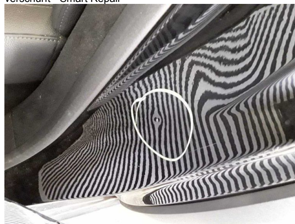
Beschädigung #3: Seitenwand links: Einstieg - Delle / Lackschaden - Smart Repair
