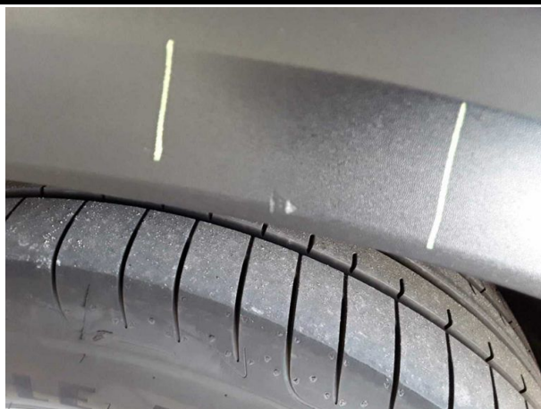
Beschädigung #4: Seitenwand links: Radhausverbreiterung - verkratzt / verschürft - erneuern
