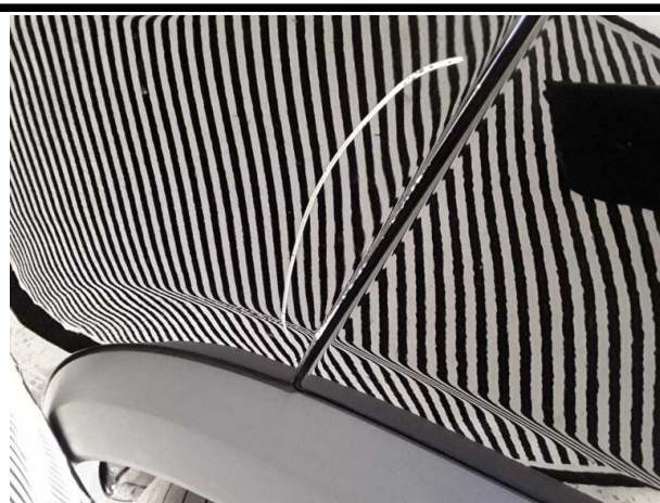
Beschädigung #8: Tür hinten links: Tür - Delle / Lackschade... instandsetzen und lackieren
