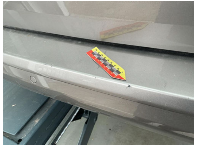
Stoßfänger hinten - zerkratzt - Lackieren
