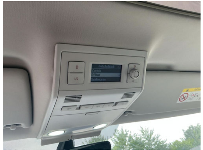
Steuergerät Aufstelldach - Fehlfunktion - erneuern
