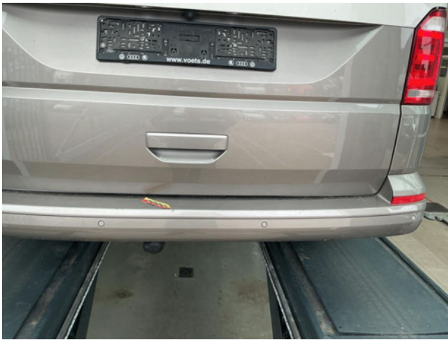
Stoßfänger hinten - zerkratzt - Lackieren
