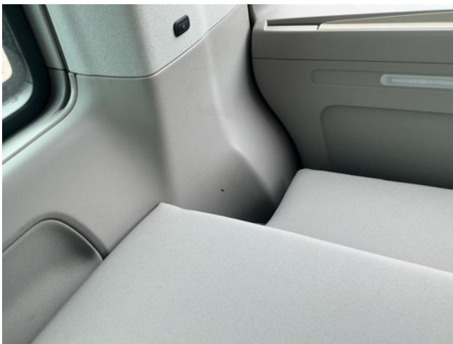
Seitenwandverkleidung - Kratzer - SR
