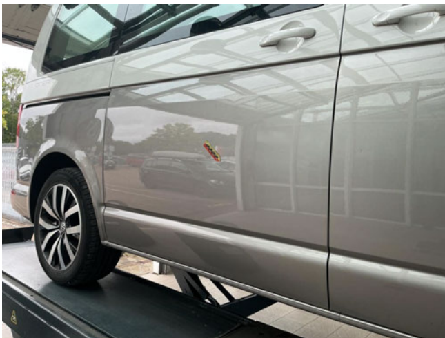
Tür hinten rechts - Delle - entfernen
