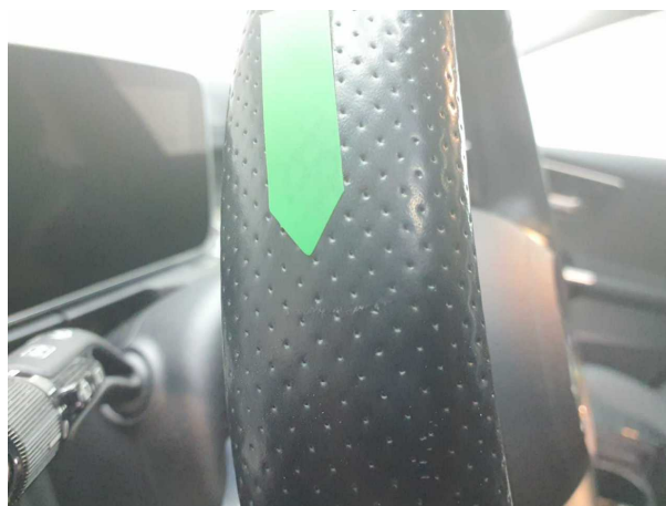
Beschädigung #5: Lenkanlage: Lenkrad - Kratzer - Smart Repair
