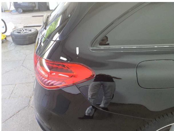
Beschädigung #9: Seitenwand rechts: Seitenwand - Kratzer - lackieren
