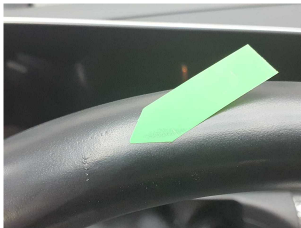
Beschädigung #5: Lenkanlage: Lenkrad - Kratzer - Smart Repair
