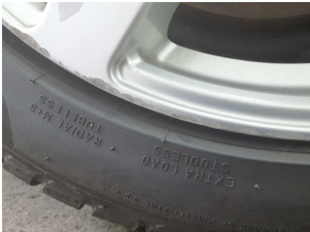
Beschädigung #1: Rad/Reifen: Leichtmetallfelge hinten rechts - Kratzer
