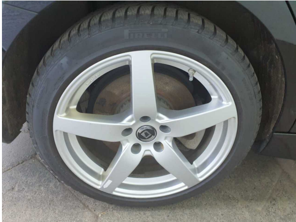
Beschädigung #1: Rad/Reifen: Leichtmetallfelge hinten rechts - Kratzer
