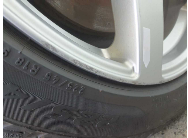
Beschädigung #1: Rad/Reifen: Leichtmetallfelge hinten rechts - Kratzer
