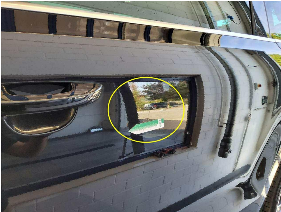
Bild 16 : Tür hinten links Lackierung, zerkratzt, lackieren
