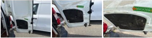
Boot door lining R, Broken, Replace
