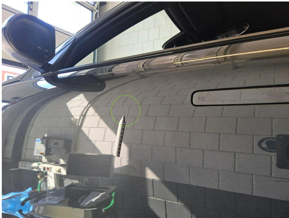
Bild 14 : Tür vorne links, eingedellt, drücken
