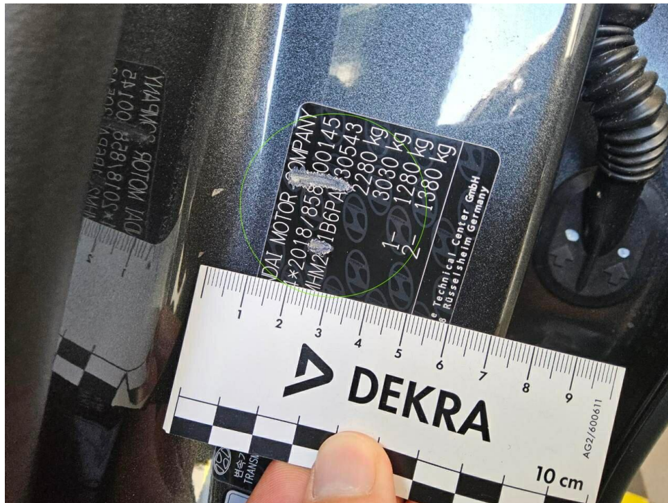
Bild 7 : Tür vorne links Einstieg Lackierung, verschrammt, smart repair
