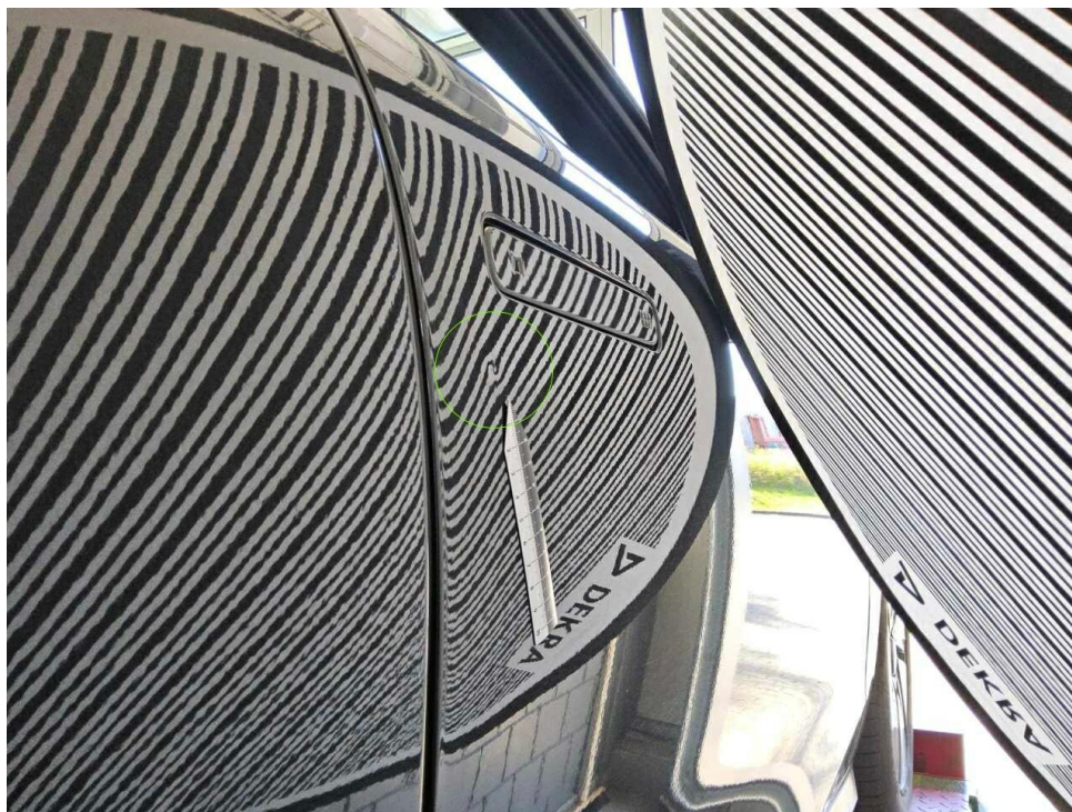
Bild 11 : Tür vorne rechts, eingedellt, drücken
