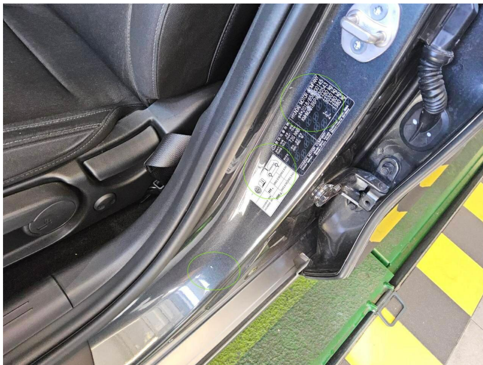
Bild 10 : Tür vorne links Einstieg Lackierung, verschrammt, smart repair
