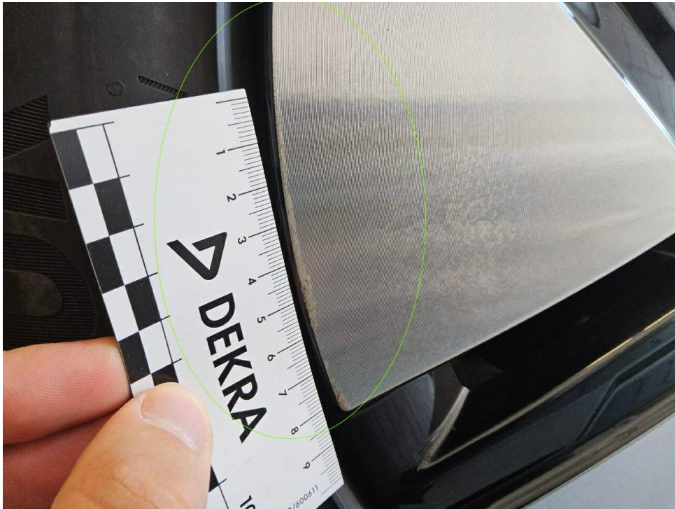
Bild 20 : Felge Hinten Rechts Verschrammt
