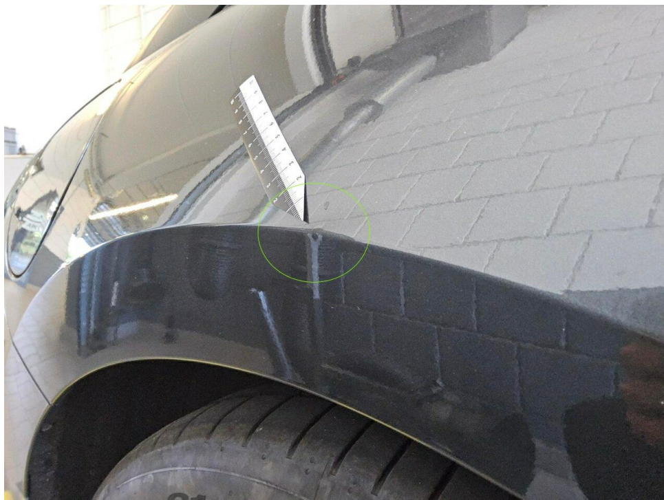
Bild 15 : Seitenteil hinten rechts, eingedellt, Gebrauchsspur
