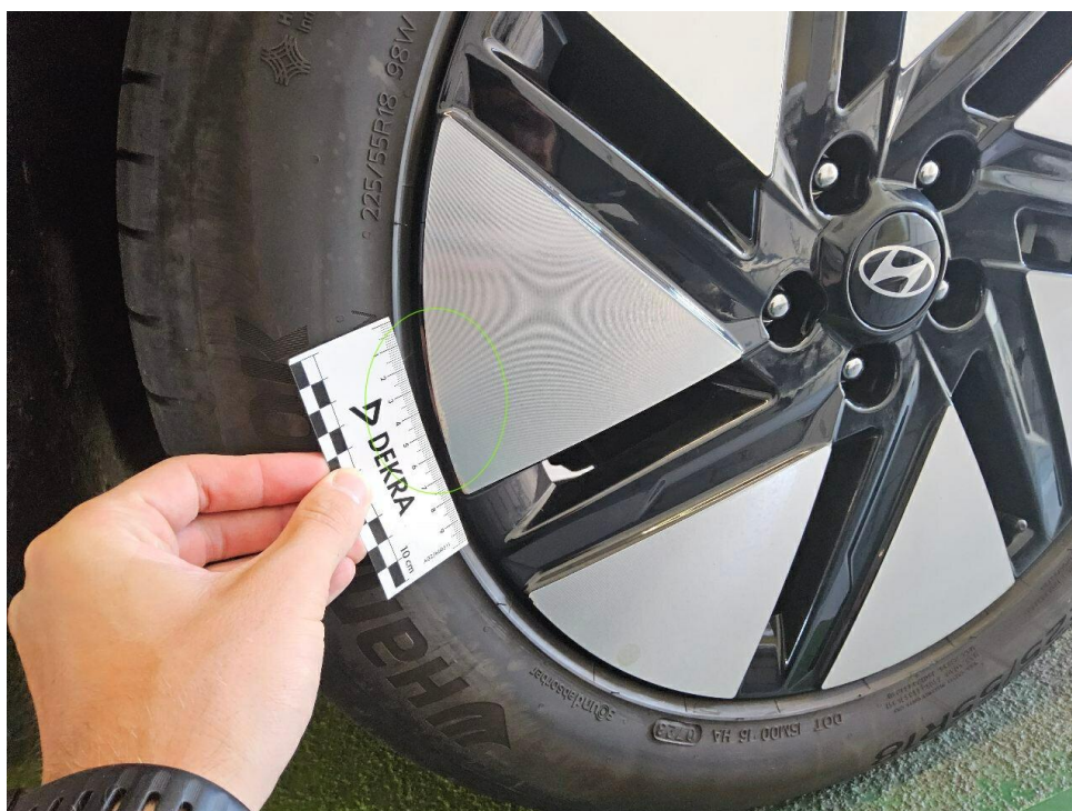
Bild 19 : Felge Hinten Rechts Verschrammt
