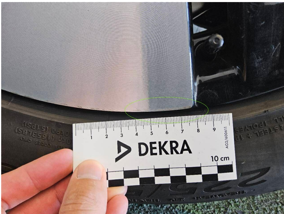
Bild 21 : Felge Hinten Rechts Verschrammt
