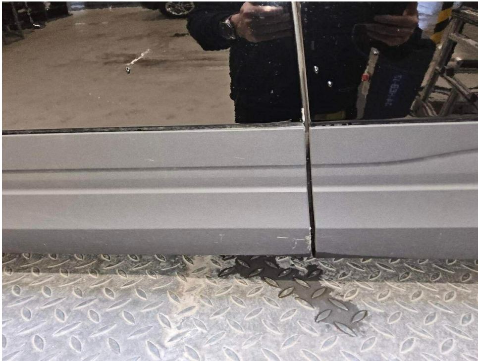
Bild 28 : Türleiste vorne links Tür vorne links Türkante, zerkratzt, smart repair
