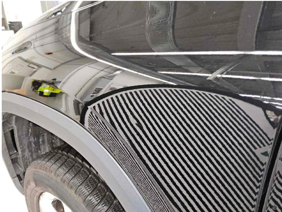
Bild 36 : Kotflügel vorne links, eingedellt, instandsetzen und lackieren mit Lackaufbau
