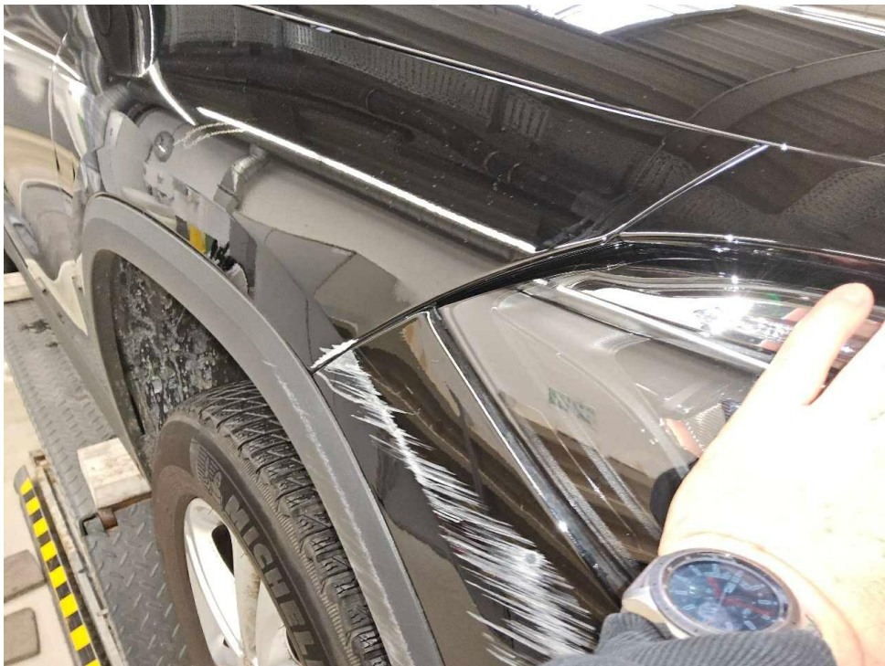
Bild 35 : Frontschaden rechts, Scheinwerfer ausgebrochen
