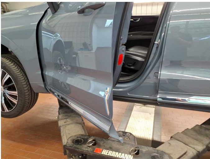
Damage 3: Door - front left side: Door edge - Scratch(es) - Smart repair
