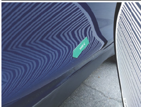
Tür / Vorne Rechts / Kratzer
