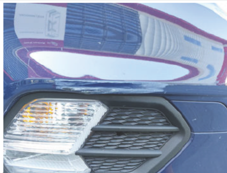
Stoßfänger / Vorne Rechts / Kratzer
