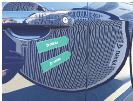
Tür / Vorne Links / Delle
