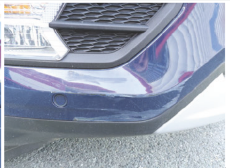
Stoßfänger / Vorne Rechts / Kratzer
