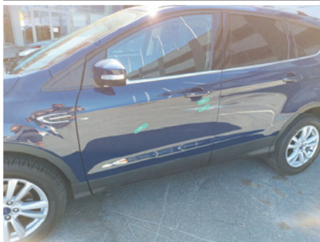
Tür / Vorne Links / Delle
