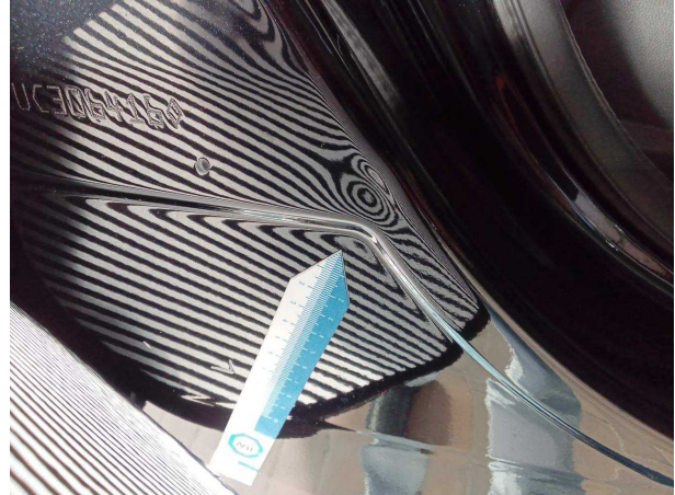
Beschädigung #1: Karosserie: B-Säule rechts - Delle(n) - sanft instandsetzen
