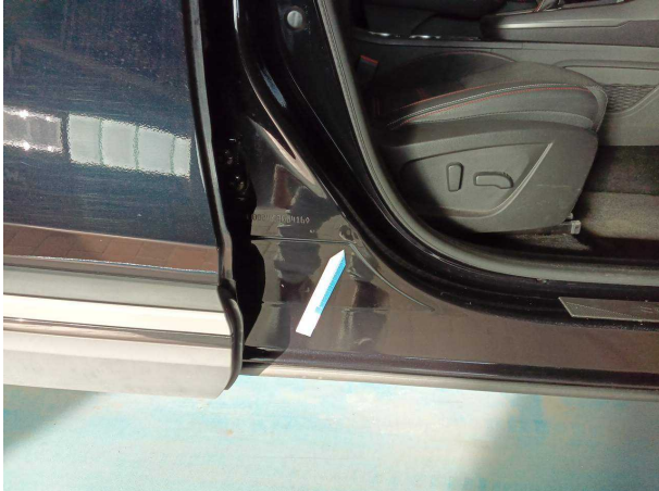
Beschädigung #1: Karosserie: B-Säule rechts - Delle(n) - sanft instandsetzen
