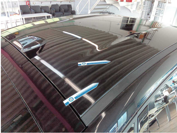
Beschädigung #4: Fahrzeugdach: Dach - Delle(n) - sanft instandsetzen
