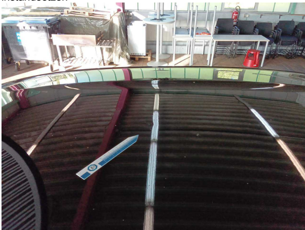
Beschädigung #4: Fahrzeugdach: Dach - Delle(n) - sanft instandsetzen
