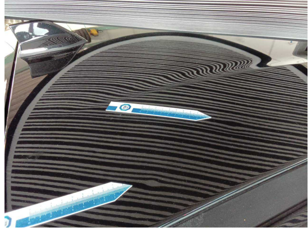
Beschädigung #4: Fahrzeugdach: Dach - Delle(n) - sanft instandsetzen
