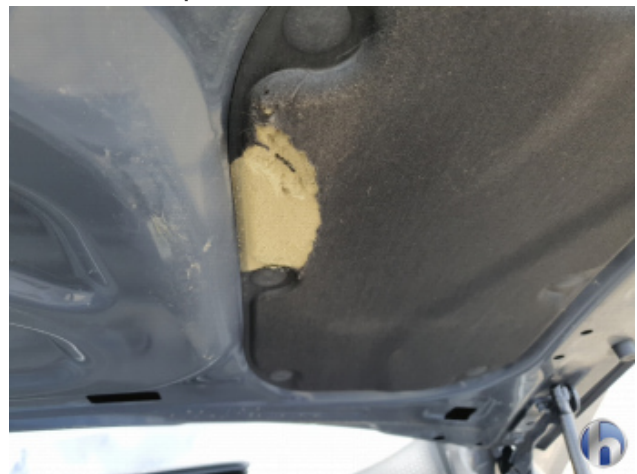
6. Motordämmmaterial Beschädigt - Erneuern
