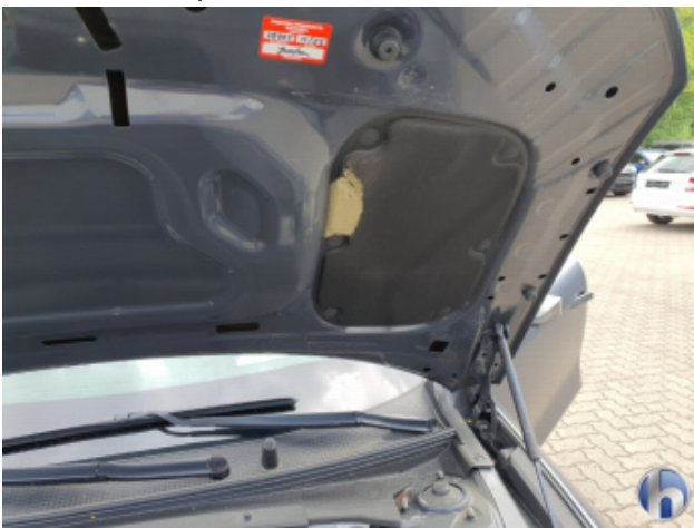
6. Motordämmmaterial Beschädigt - Erneuern
