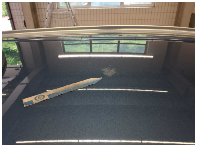
Damage 8: Roof: Roof (Verätzung) - Paint defect - Paint
