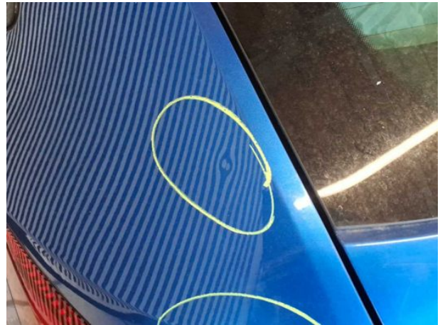
Beschädigung #6: Seitenwand links: Seitenwand - Delle / Lackschaden - Smart Repair
