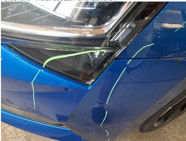
Beschädigung #17: Scheinwerfer: LED-Scheinwerfer links - beschädigt - erneuern
