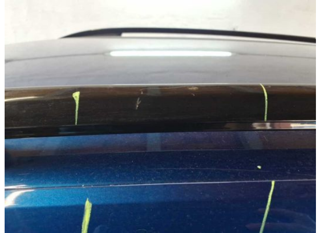
Beschädigung #3: Fahrzeugdach: Dachreling links - verkratzt... verschürft - Wertminderung
