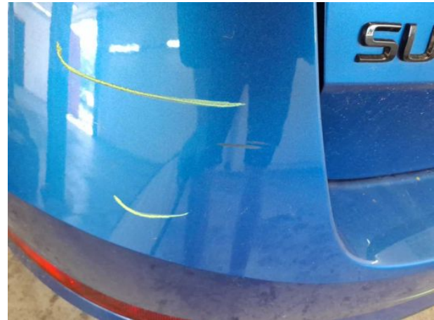
Beschädigung #13: Stossfänger hinten: Stossfänger hinten - verkratzt / verschürft - instandsetzen und lackieren
