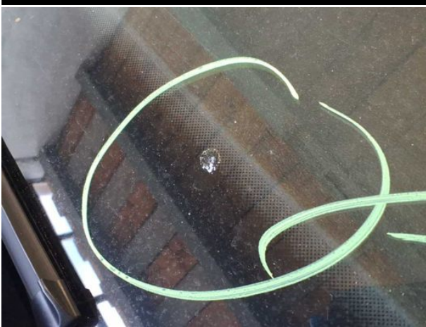
Beschädigung #12: Verglasung: Frontscheibe - Steinschlag - erneuern
