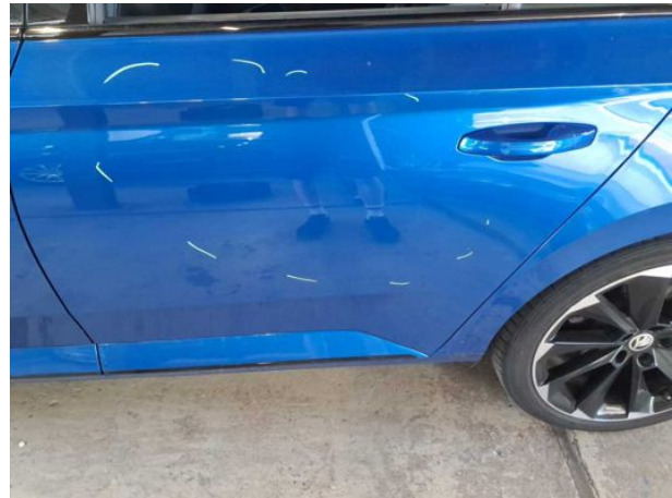
Beschädigung #11: Tür hinten links: Tür - verkratzt / verschü... - instandsetzen und lackieren
