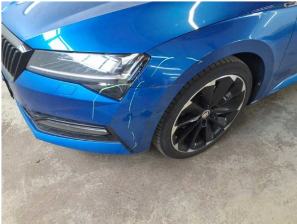
Beschädigung #15: Stossfänger vorn: Stossfänger vorn - verkratzt / verschürft - instandsetzen und lackieren
