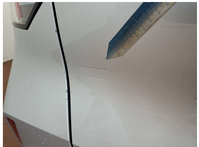
Damage 11: Boot lid / rear door: Boot lid - Scratch(es) - Paint
