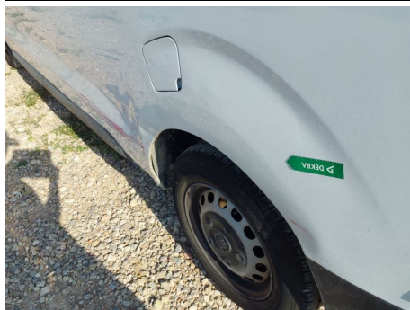
Panel lateral / Trasero Izquierdo / Abolladura
