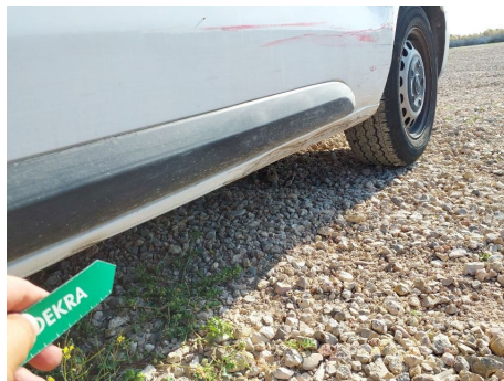
Estribo / Izquierda / Abolladura
