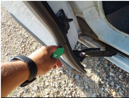
Junta de entrada de puerta / Trasero Derecho / Roto
