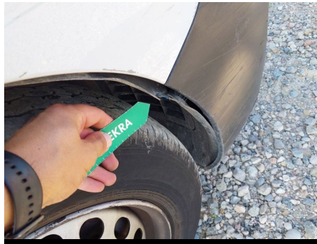
Guarnecido del paso de rueda / Delantero Derecho / Roto
