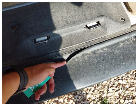
Junta de marco de puerta / Trasero / Roto
