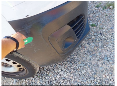
Spoiler / Delantero / Abolladura
