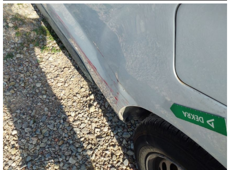
Panel lateral / Trasero Izquierdo / Abolladura
