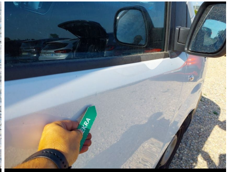
Puerta / Delantero Derecho / Abolladura
