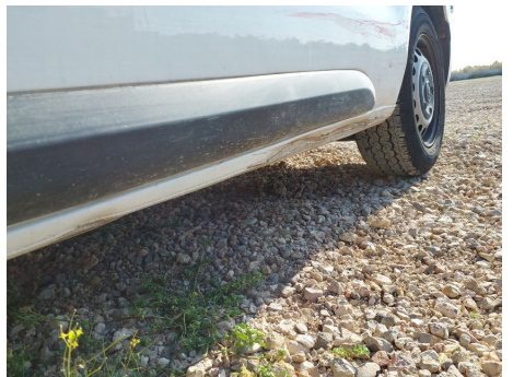
Estribo / Izquierda / Abolladura
