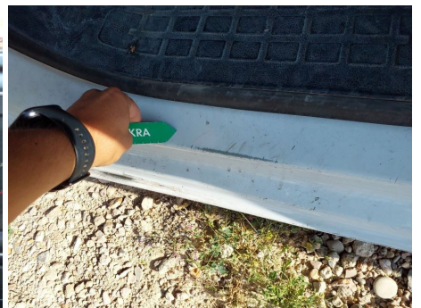
Travesaño de la puerta / Delantero izquierdo / Abolladura
