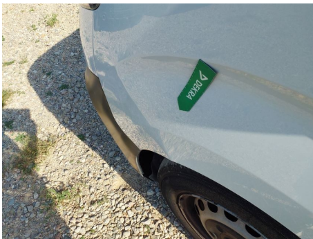
Aleta / Delantero Izquierdo / Abolladura
