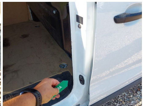
Junta de marco de puerta / Trasero Derecho / Faltante
