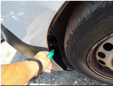
Guarnecido del paso de rueda / Delantero Izquierdo / Roto
