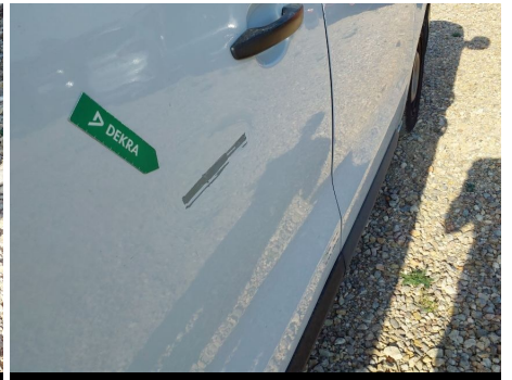
Puerta / Trasero Derecho / Abolladura
