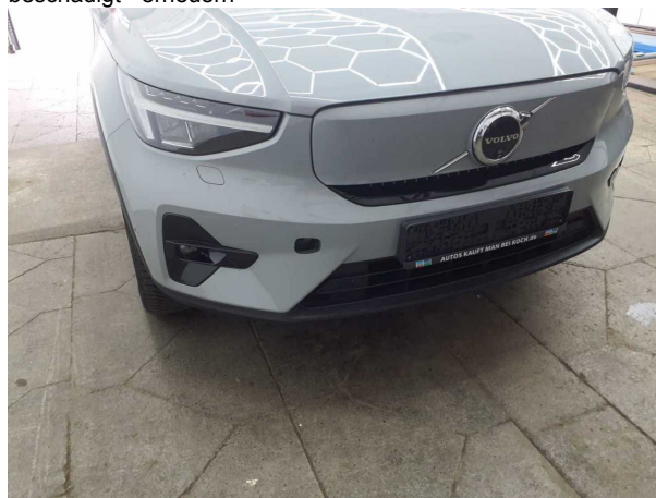
Beschädigung #8: Stossfänger vorn: Blende Stossfänger vorn (Blende Abschlepphaken) - fehlt - erneuern
