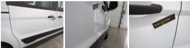
Boot door lining R, Broken, Replace
