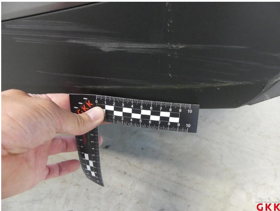
Bild 16. Stoßfänger hinten, Verkleidung unterhalb -unlackiert-, verkratzt, ersetzen
