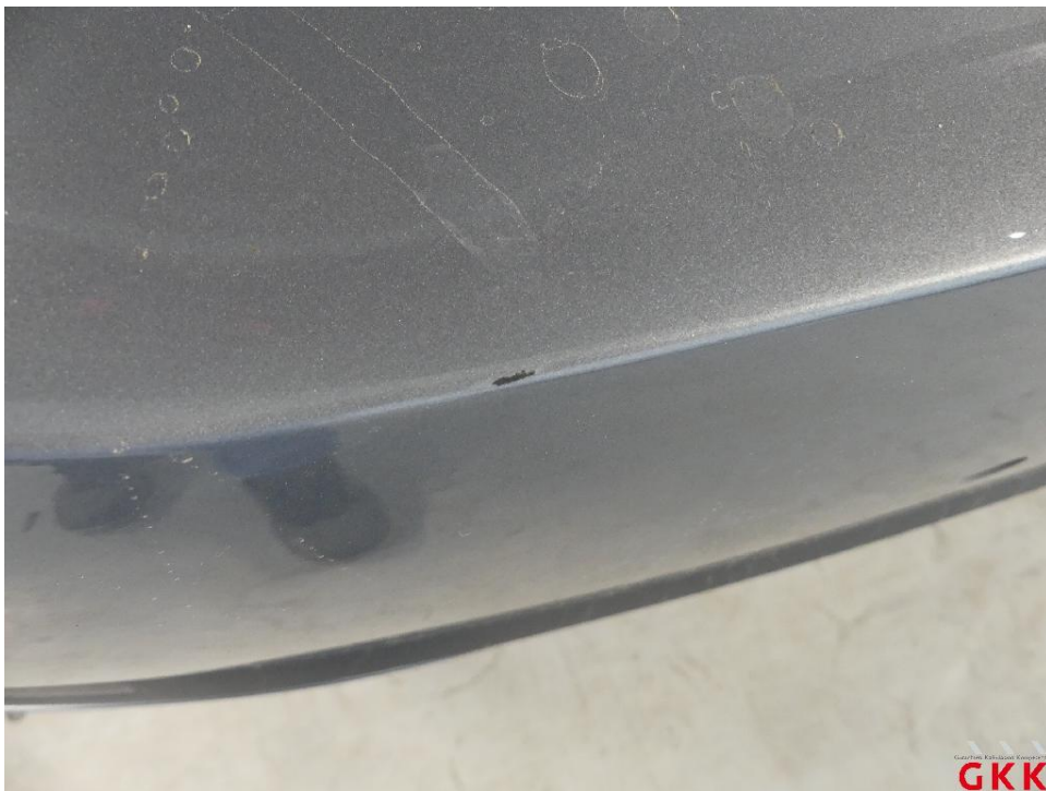
Bild 20. Stoßfänger hinten, Verkleidung -lackiert-, verkratzt, lackieren
