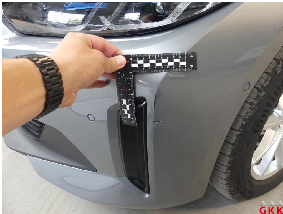
Bild 12. Stoßfänger vorne, Verkleidung -lackiert-, verkratzt, lackieren
