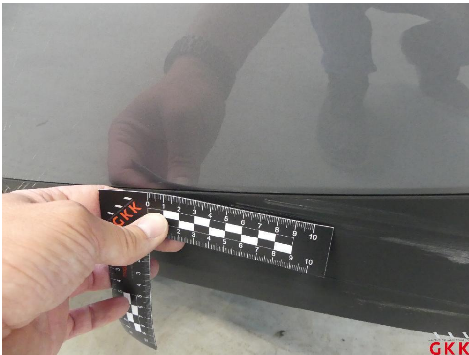
Bild 18. Stoßfänger hinten, Verkleidung -lackiert-, verkratzt, lackieren
