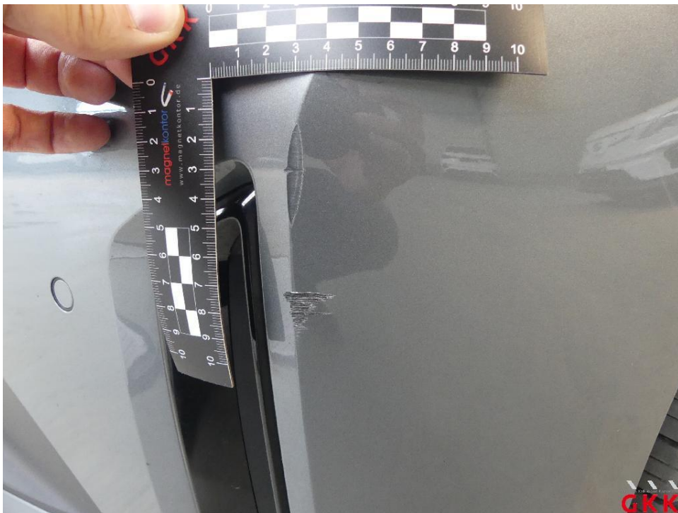
Bild 14. Stoßfänger vorne, Verkleidung -lackiert-, verkratzt, lackieren
