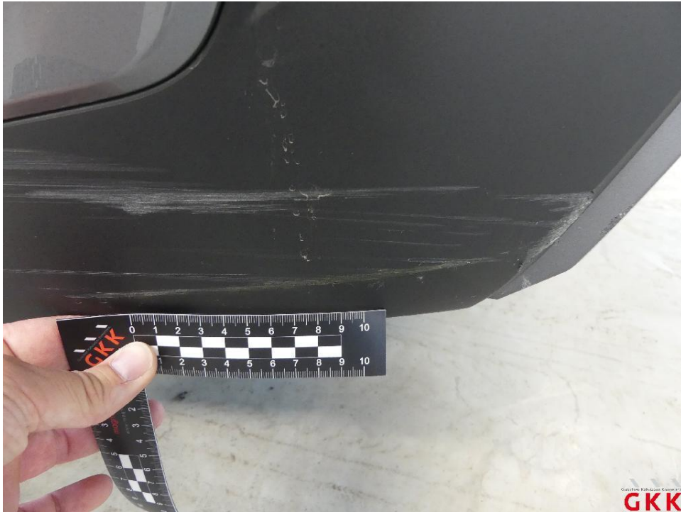
Bild 17. Stoßfänger hinten, Verkleidung unterhalb -unlackiert-, verkratzt, ersetzen
