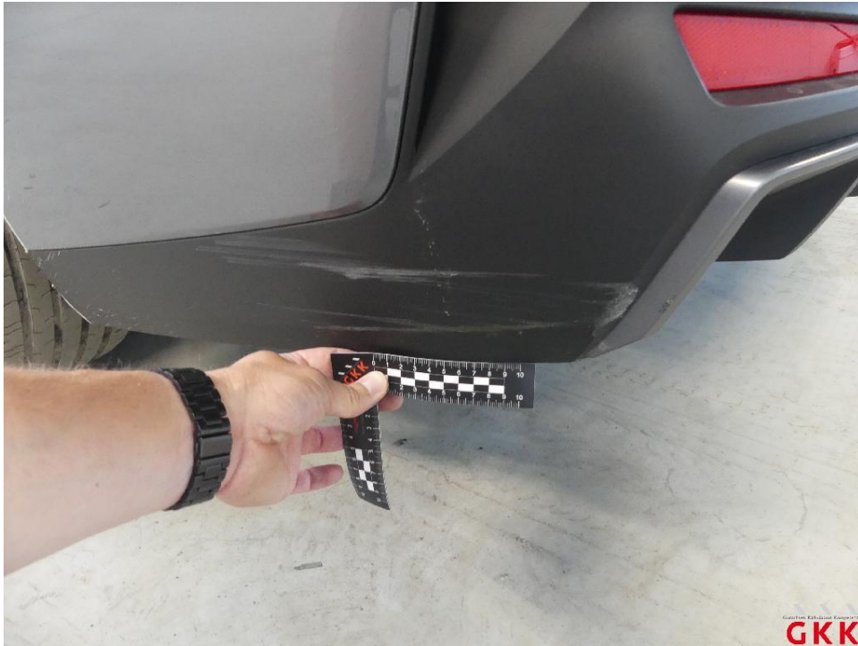
Bild 15. Stoßfänger hinten, Verkleidung unterhalb -unlackiert-, verkratzt, ersetzen
