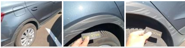
Door RR, Scratch(es), Acceptable
