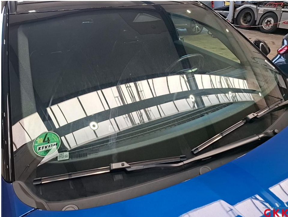
Bild 16. Frontscheibe, mit Regensensor, Frontkamera und Head-up-Display, verkratzt, ersetzen
