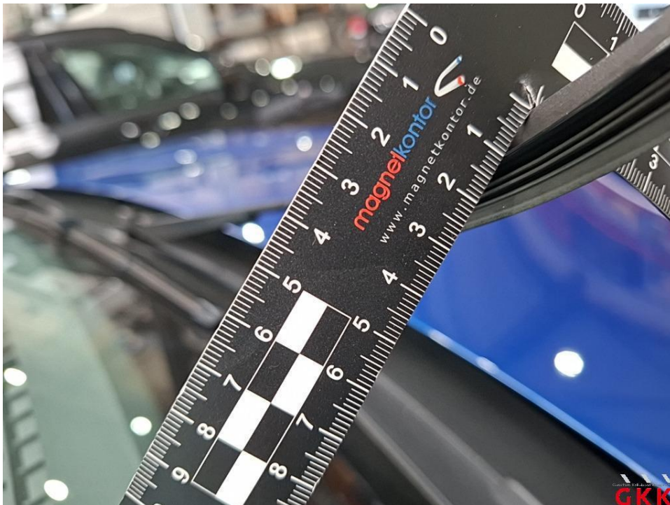
Bild 20. Scheibenwischer vorne, Blatt -rechts-, beschädigt, ersetzen
