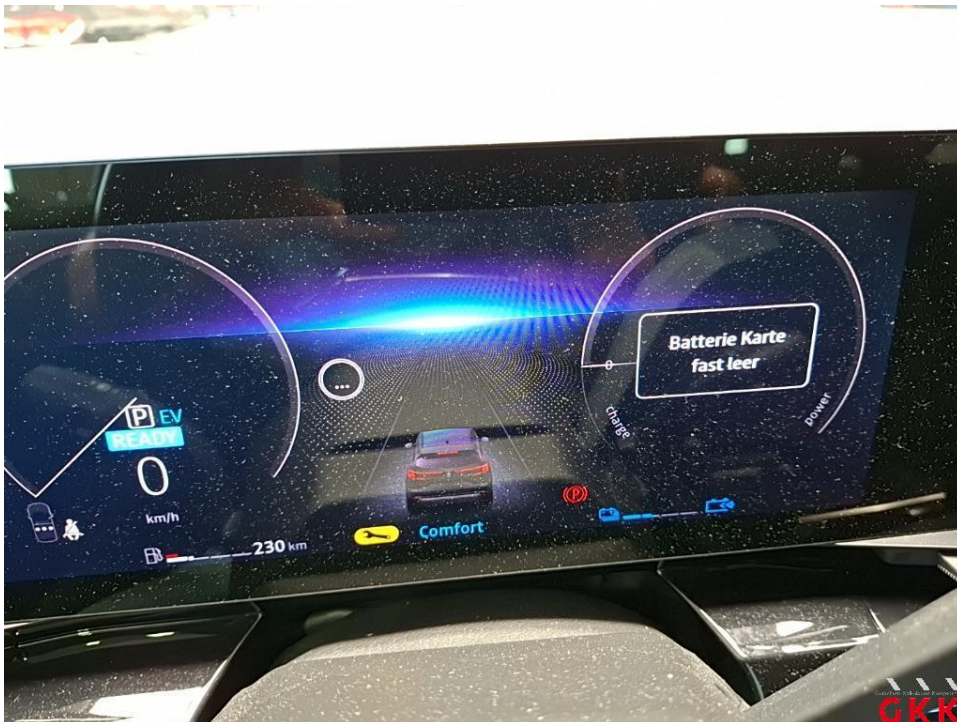
Bild 14. Hauptschlüssel, Batterie, entladen, ersetzen
