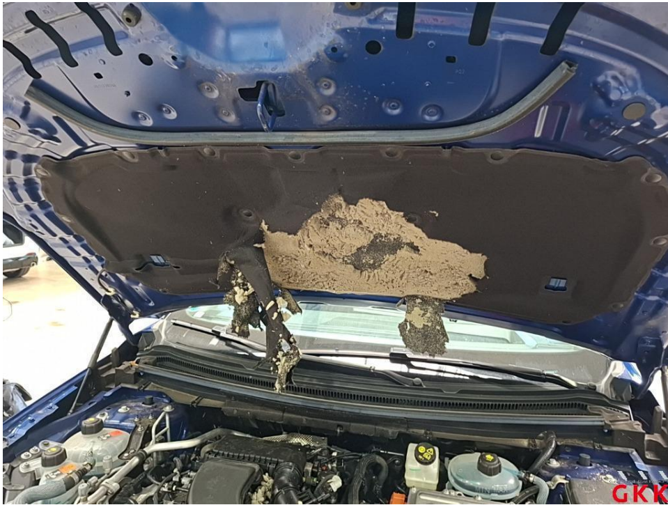
Bild 15. Motorhaube, Dämmmatte, beschädigt, ersetzen
