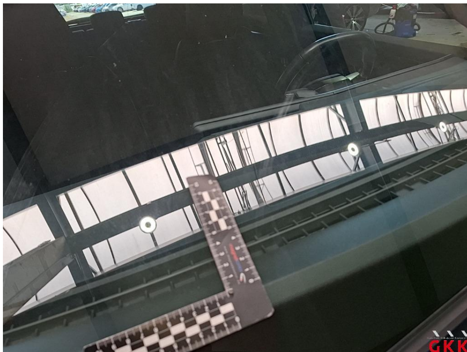
Bild 18. Frontscheibe, mit Regensensor, Frontkamera und Head-up-Display, verkratzt, ersetzen
