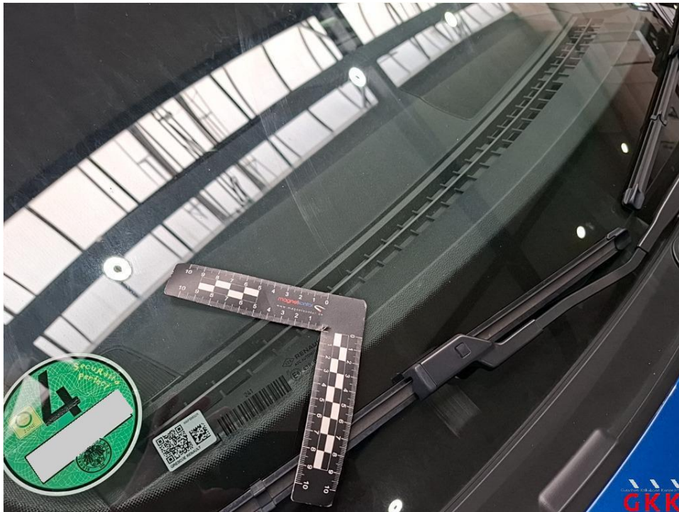
Bild 19. Scheibenwischer vorne, Blatt -rechts-, beschädigt, ersetzen
