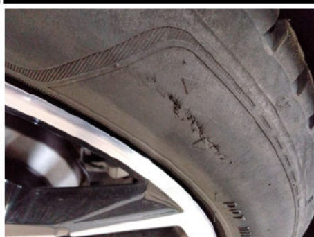
Reifen / Hinten Rechts / Gebrochen
