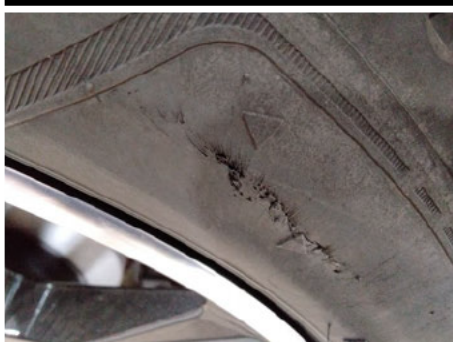
Reifen / Hinten Rechts / Gebrochen
