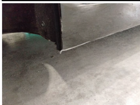
Schwellerverkleidung / Rechts / Kratzer
