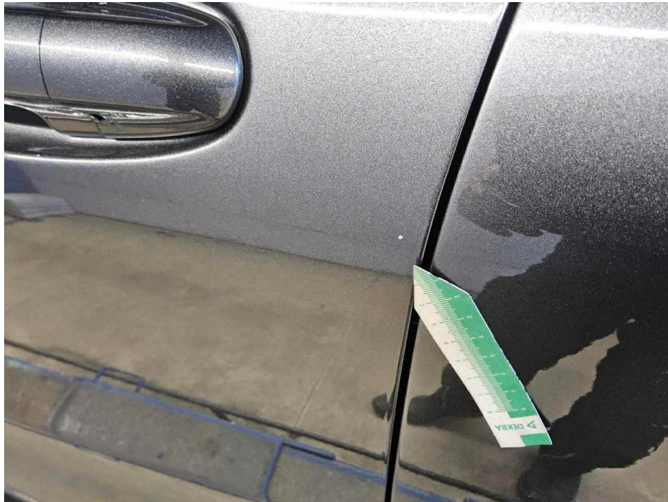
Bild 25 : Tür vorne links Lackierung, zerkratzt, Gebrauchsspur
