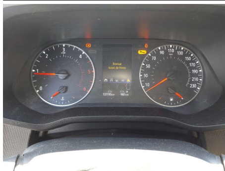
Indicador del sistema de frenado / Defectuoso
