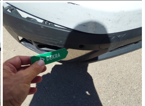
Sensor de estacionamiento / Delantero Derecho / Faltante
