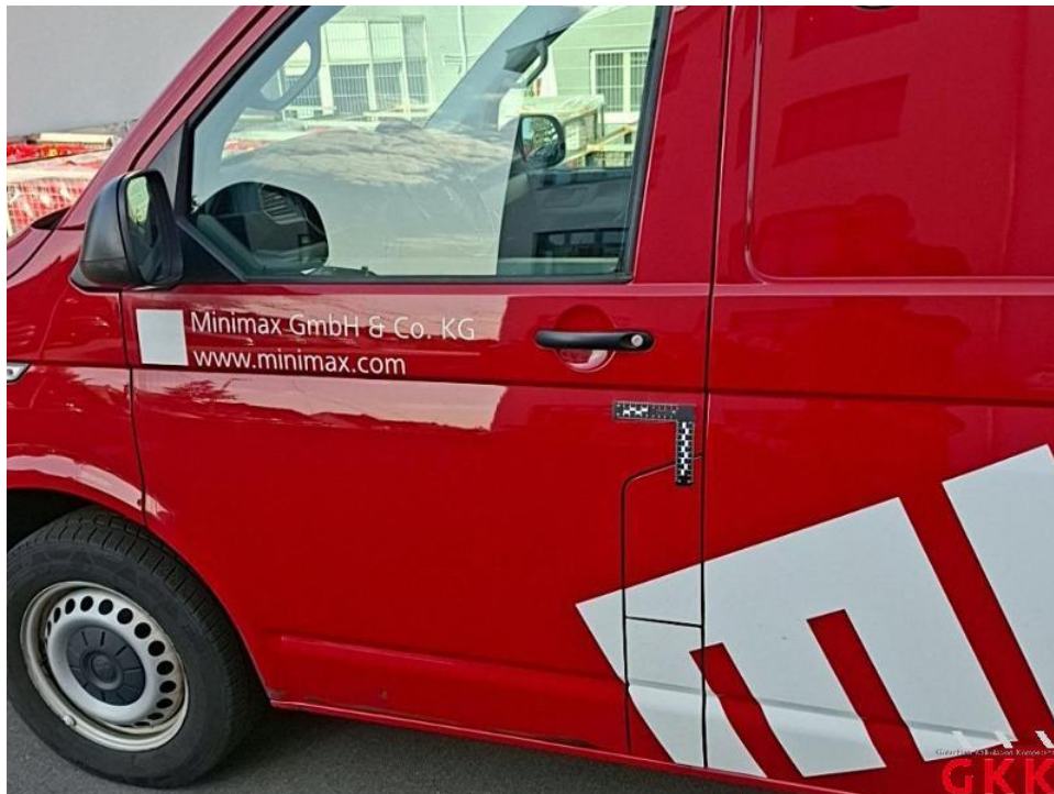
Bild 31. Tür vorne links, Kante, verkratzt, auslegen, schleifen, polieren
