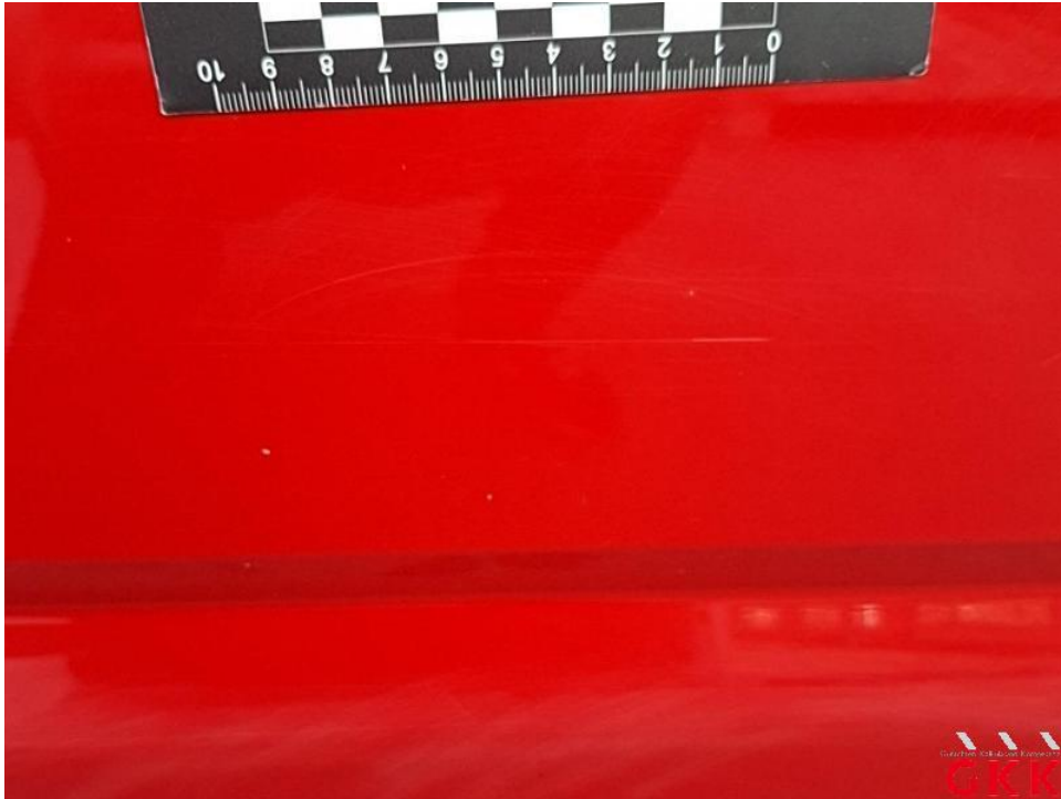
Bild 13. Schiebetür rechts, verkratzt, lackieren
