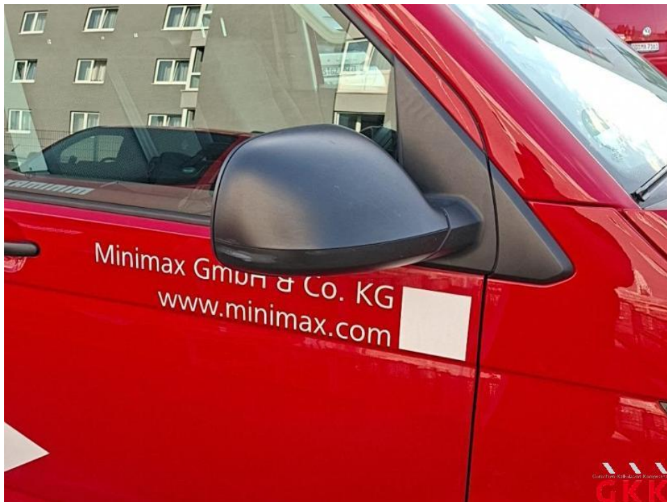
Bild 18. Spiegelgehäuse rechts, Kappe -unlackiert-, verkratzt, Smartrepair
