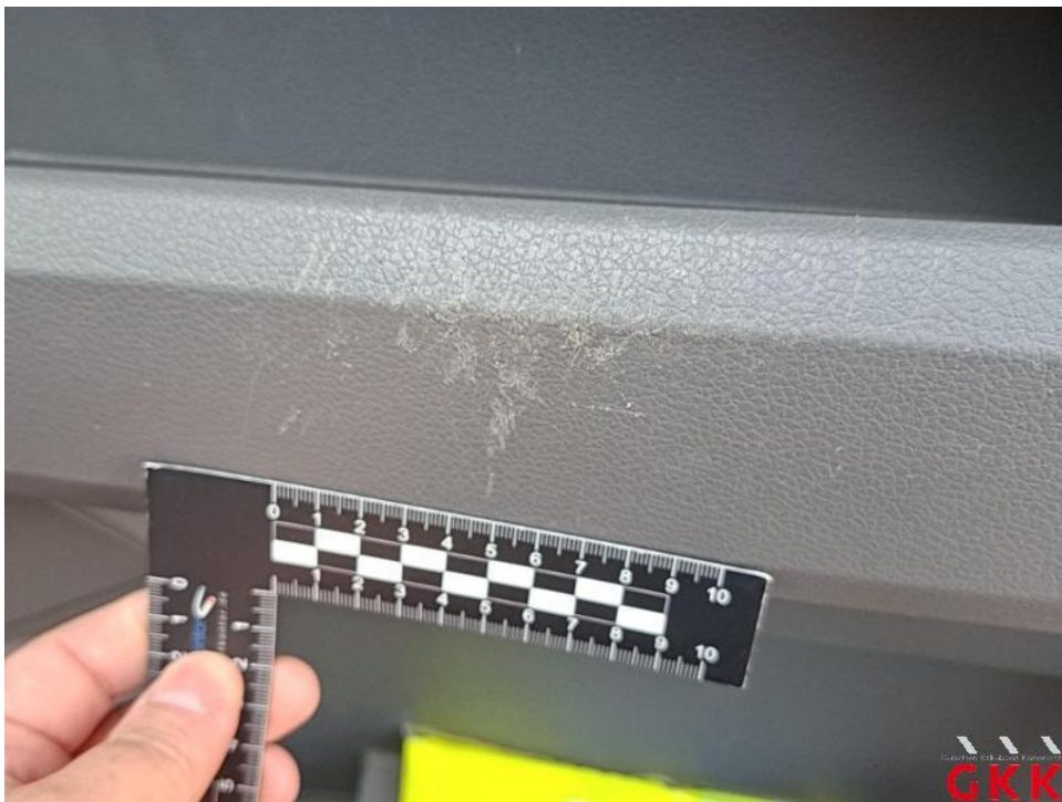
Bild 16. Tür vorne rechts, Innenverkleidung -Standard-, verkratzt, ersetzen
