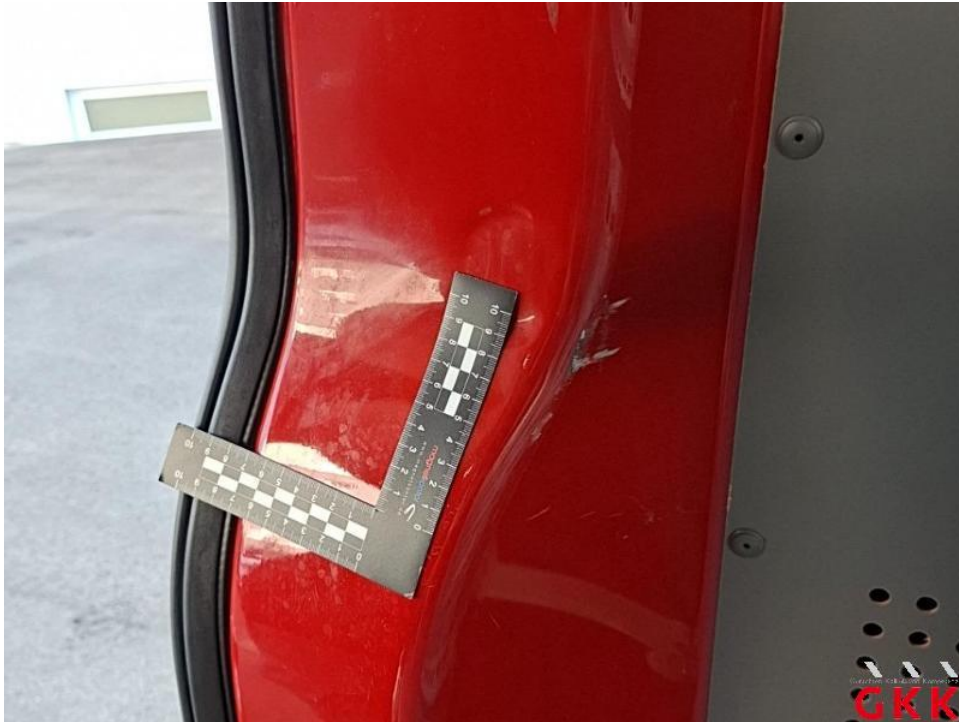
Bild 51. D- Säule links, verkratzt, lackieren
