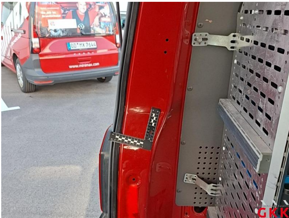
Bild 50. D- Säule links, verkratzt, lackieren
