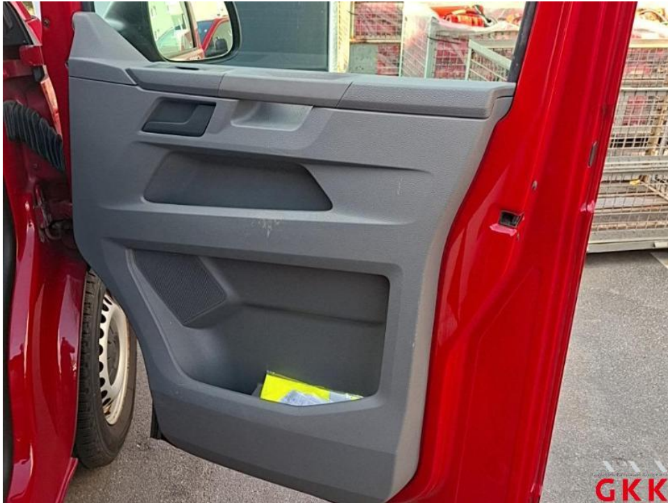
Bild 15. Tür vorne rechts, Innenverkleidung -Standard-, verkratzt, ersetzen
