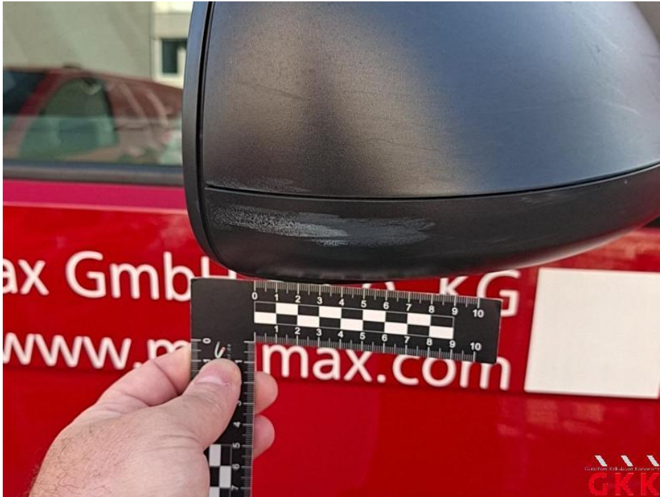
Bild 19. Spiegelgehäuse rechts, Kappe -unlackiert-, verkratzt, Smartrepair
