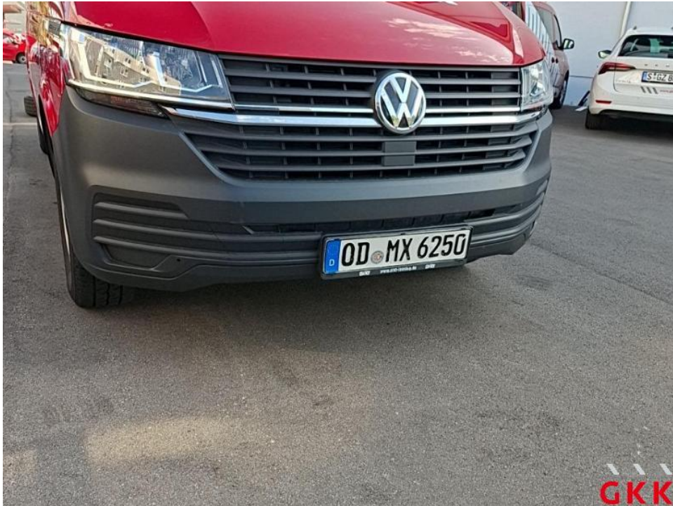
Bild 23. Stoßfänger vorne, Verkleidung -unlackiert-, verkratzt, Smartrepair
