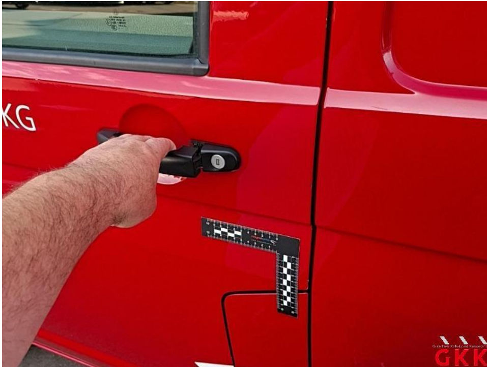
Bild 35. Tür vorne links, schwergängig, prüfen
