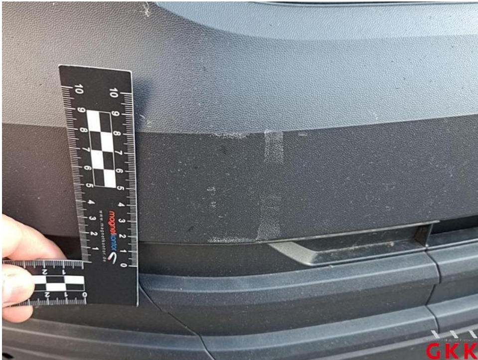
Bild 24. Stoßfänger vorne, Verkleidung -unlackiert-, verkratzt, Smartrepair
