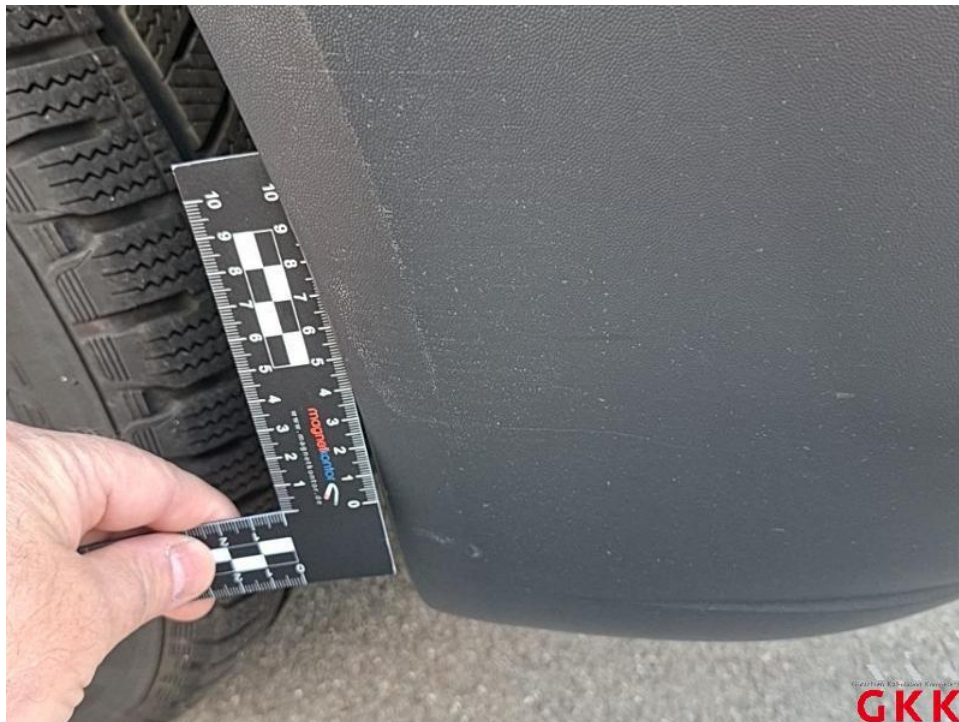
Bild 25. Stoßfänger vorne, Verkleidung -unlackiert-, verkratzt, Smartrepair
