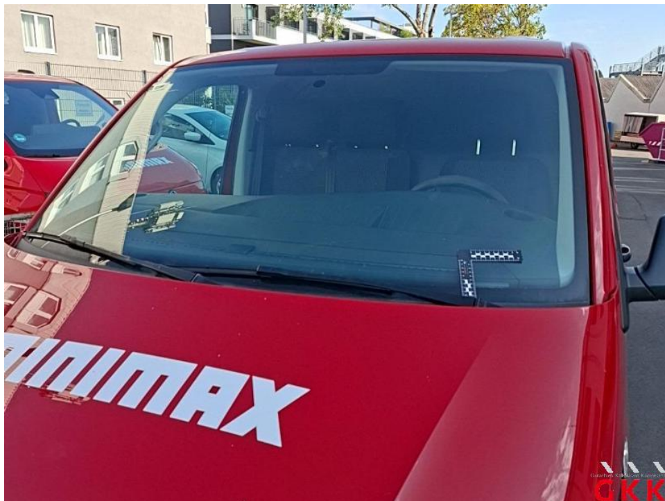
Bild 26. Frontscheibe, Steinschlag mit Rissbildung, ersetzen
