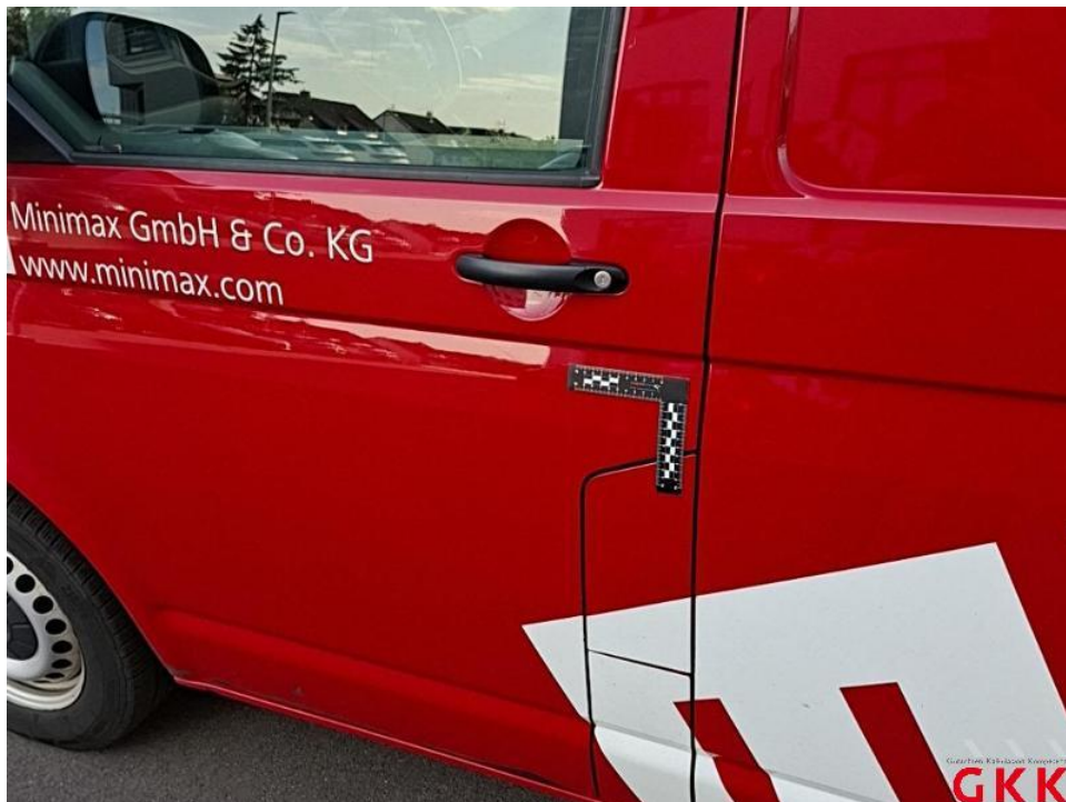
Bild 34. Tür vorne links, schwergängig, prüfen
