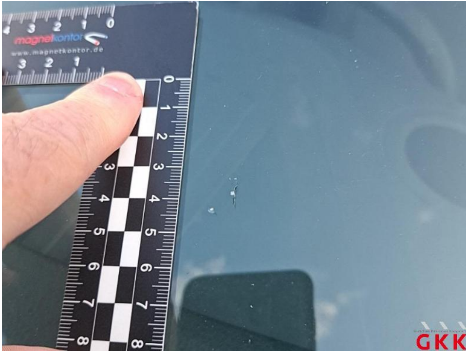
Bild 27. Frontscheibe, Steinschlag mit Rissbildung, ersetzen
