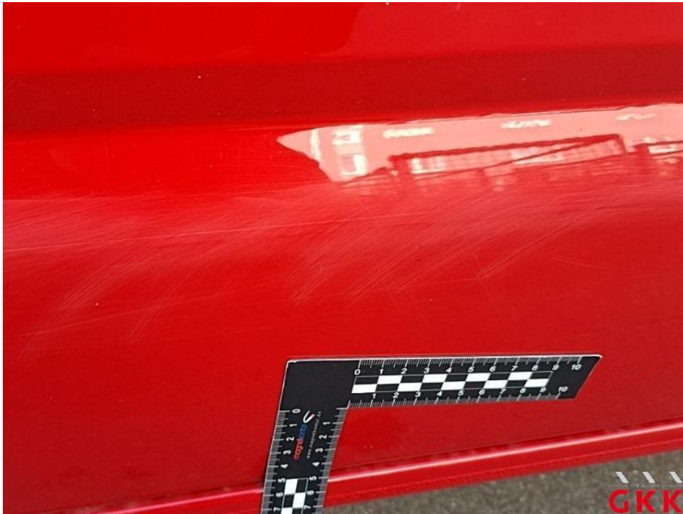
Bild 14. Schiebetür rechts, verkratzt, lackieren
