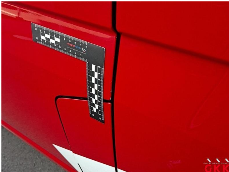
Bild 32. Tür vorne links, Kante, verkratzt, auslegen, schleifen, polieren
