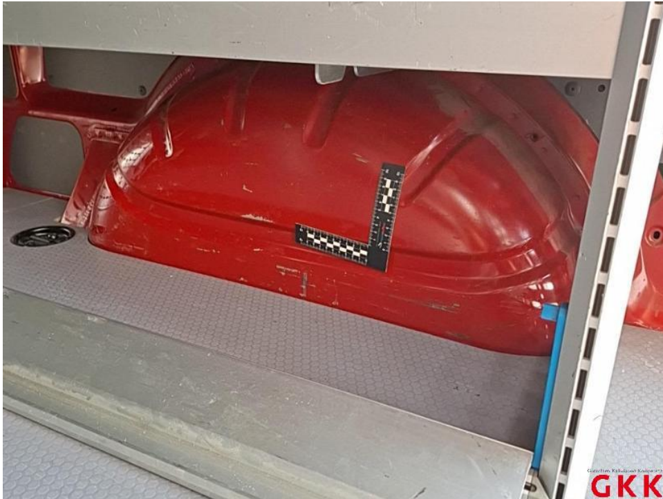
Bild 57. Radhaus hinten rechts, verkratzt, lackieren
