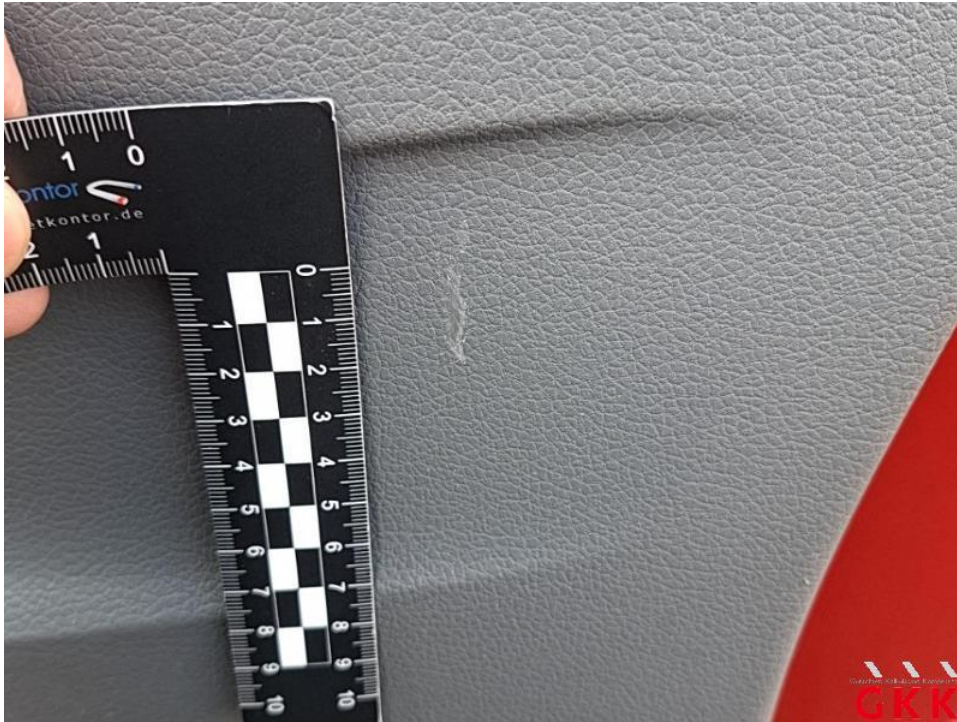
Bild 17. Tür vorne rechts, Innenverkleidung -Standard-, verkratzt, ersetzen
