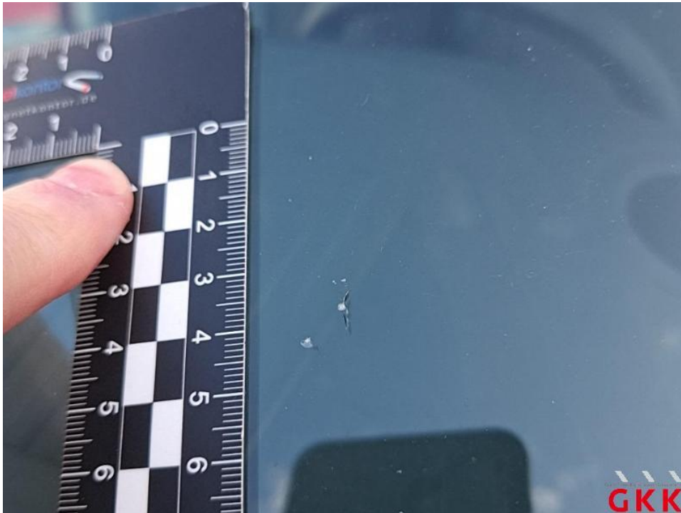
Bild 28. Frontscheibe, Steinschlag mit Rissbildung, ersetzen
