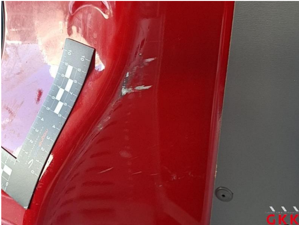
Bild 52. D- Säule links, verkratzt, lackieren
