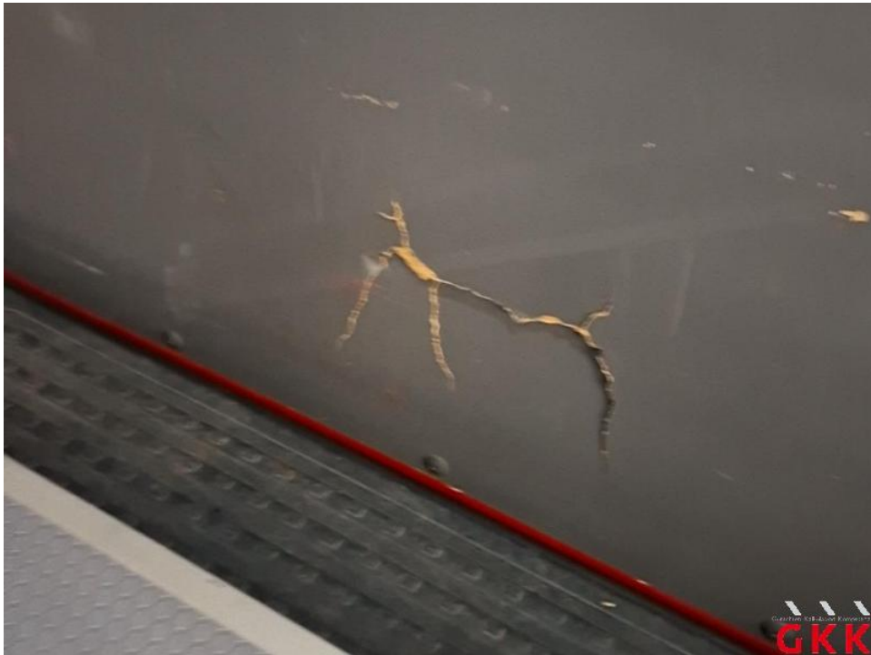
Bild 54. Schiebetür rechts, Innenverkleidung, beschädigt, ersetzen
