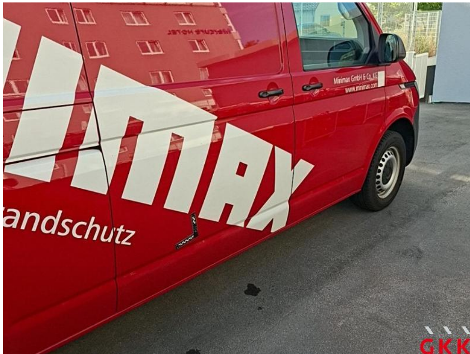
Bild 12. Schiebetür rechts, verkratzt, lackieren
