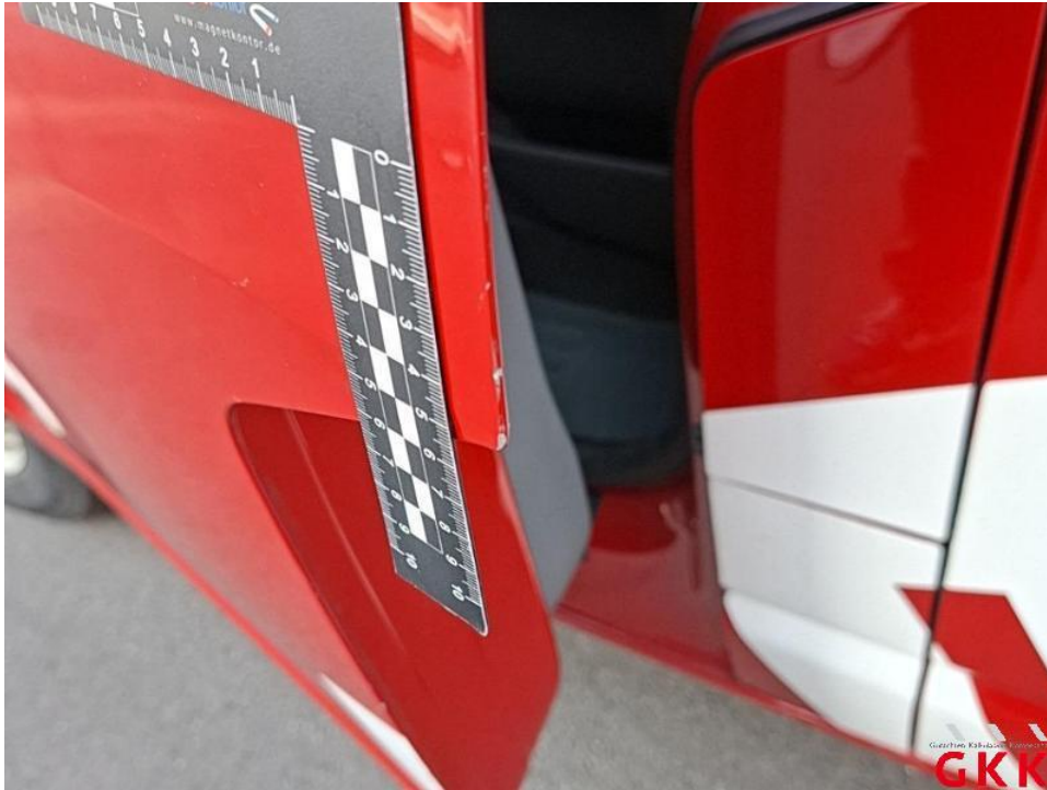
Bild 33. Tür vorne links, Kante, verkratzt, auslegen, schleifen, polieren
