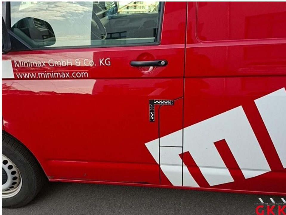
Bild 29. Tür vorne links, bis 3 Dellen / Bauteil, kalt drücken
