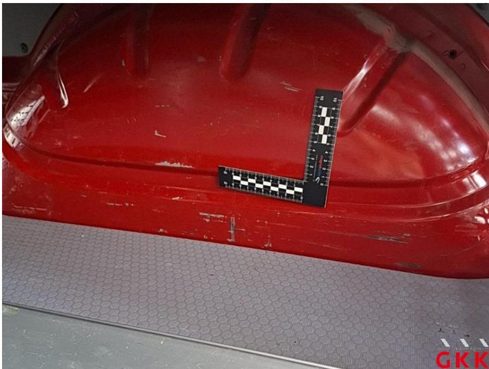
Bild 58. Radhaus hinten rechts, verkratzt, lackieren
