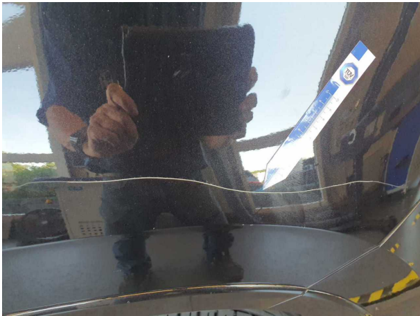
Beschädigung #6: Seitenwand links: Seitenwand - Kratzer - lackieren
