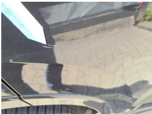
Beschädigung #3: Tür hinten rechts: Tür - Kratzer - lackieren
