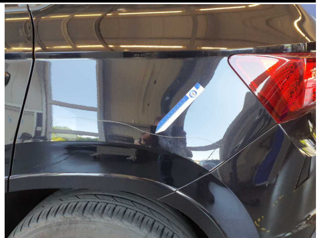
Beschädigung #6: Seitenwand links: Seitenwand - Kratzer - lackieren
