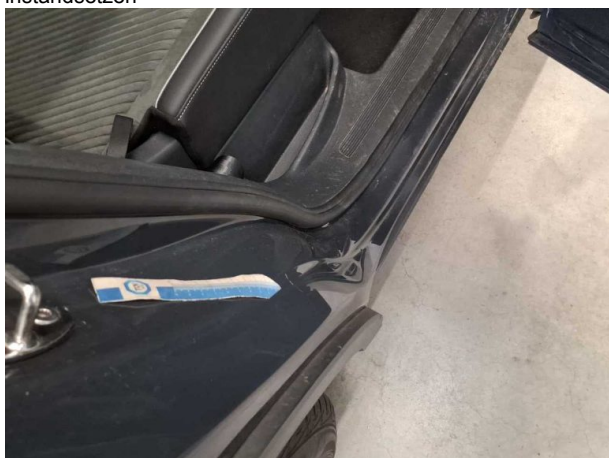
Beschädigung #3: Seitenwand rechts: Einstieg - Kratzer - Smart Repair
