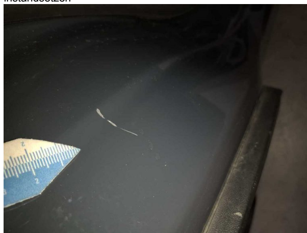
Beschädigung #3: Seitenwand rechts: Einstieg - Kratzer - Smart Repair
